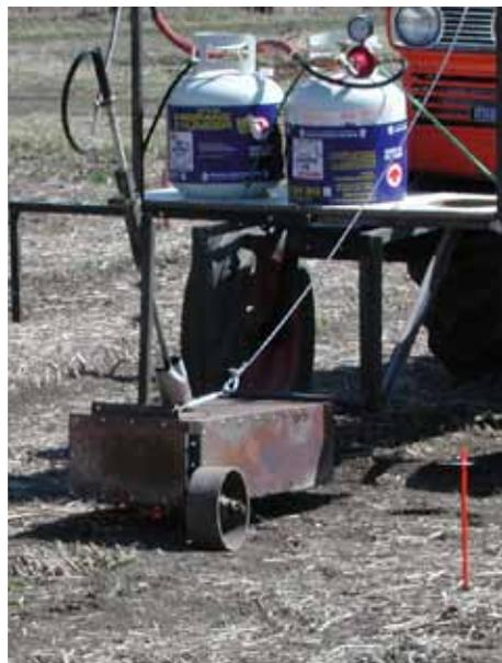
Prototype de pyrodés herbeur à flamme couverte.
