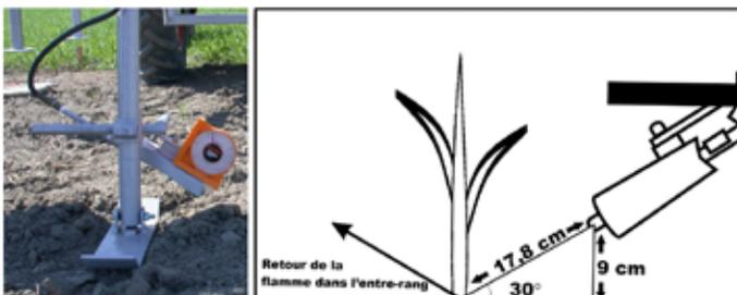
La flamme était dirigée vers la base de la culture à un angle de 30° par rapport au sol, ce qui permettait de rebondir dans l'entre-rang et de minimiser ainsi les dommages à la culture.
