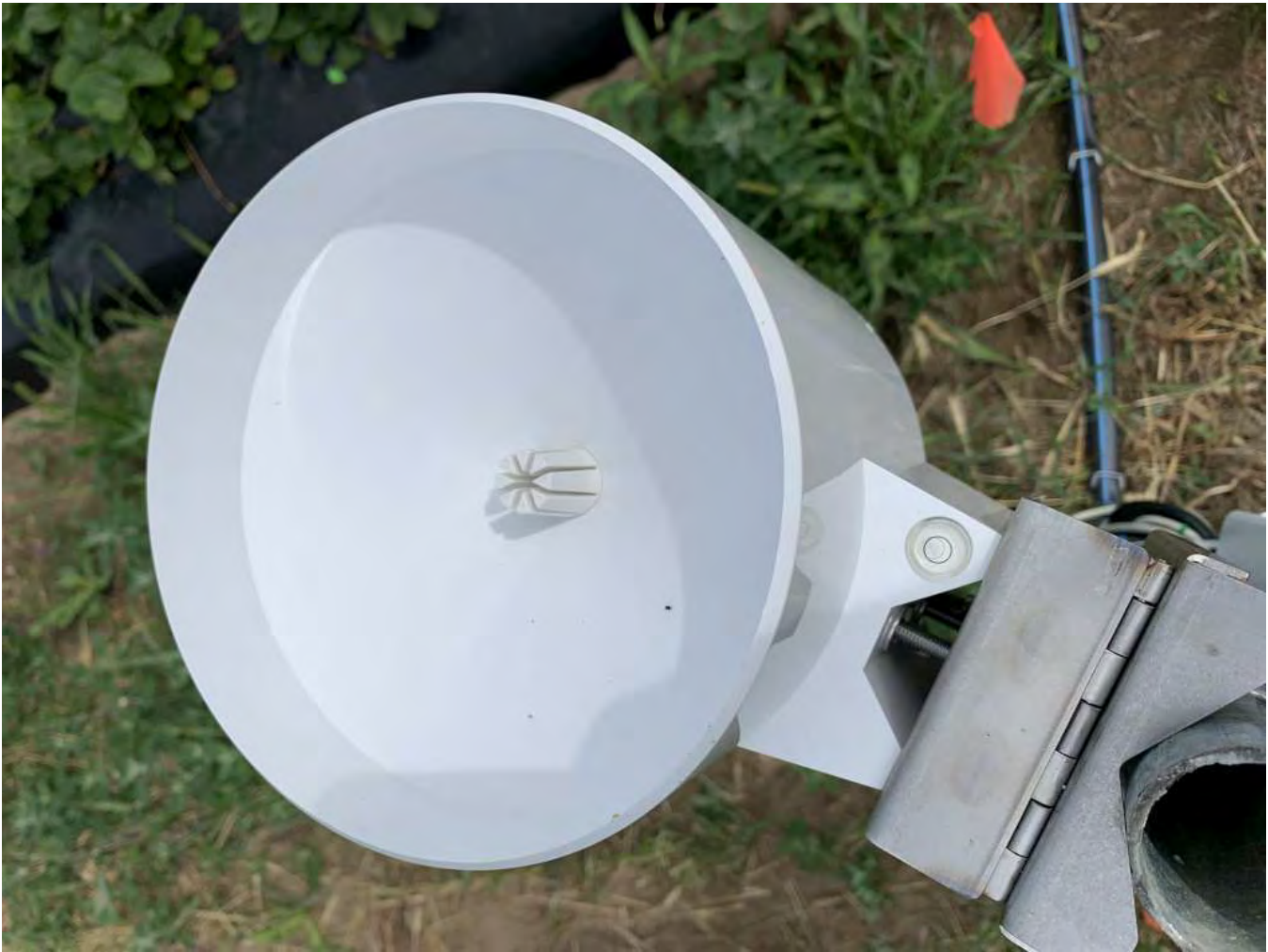
Figure 11. Pluviomètre Meter (Hoskin Scientifique), fraises sur sol butté recouvert de plastique
