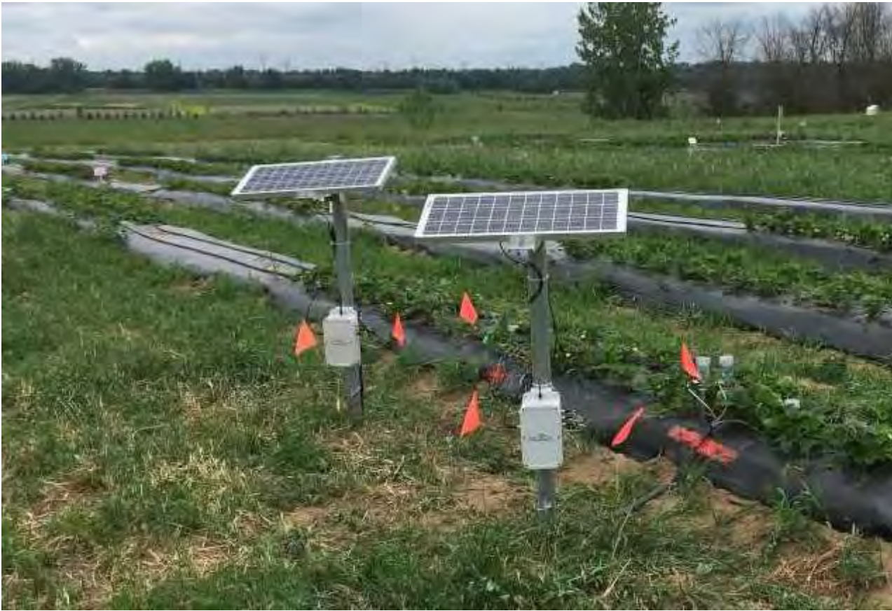
Figure 18. Modules et panneaux solaires (SimpliCollect), fraises sur sol butté recouvert de plastique
