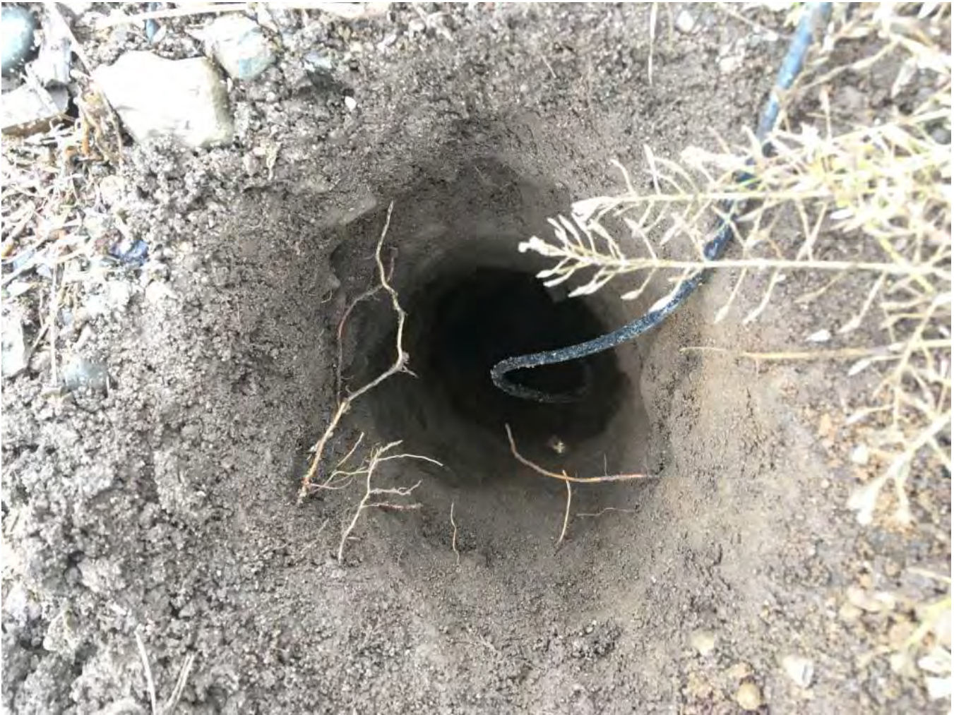
Figure 13. Installation de sondes EC-5 de Meter (Hoskin Scientifique), verger
