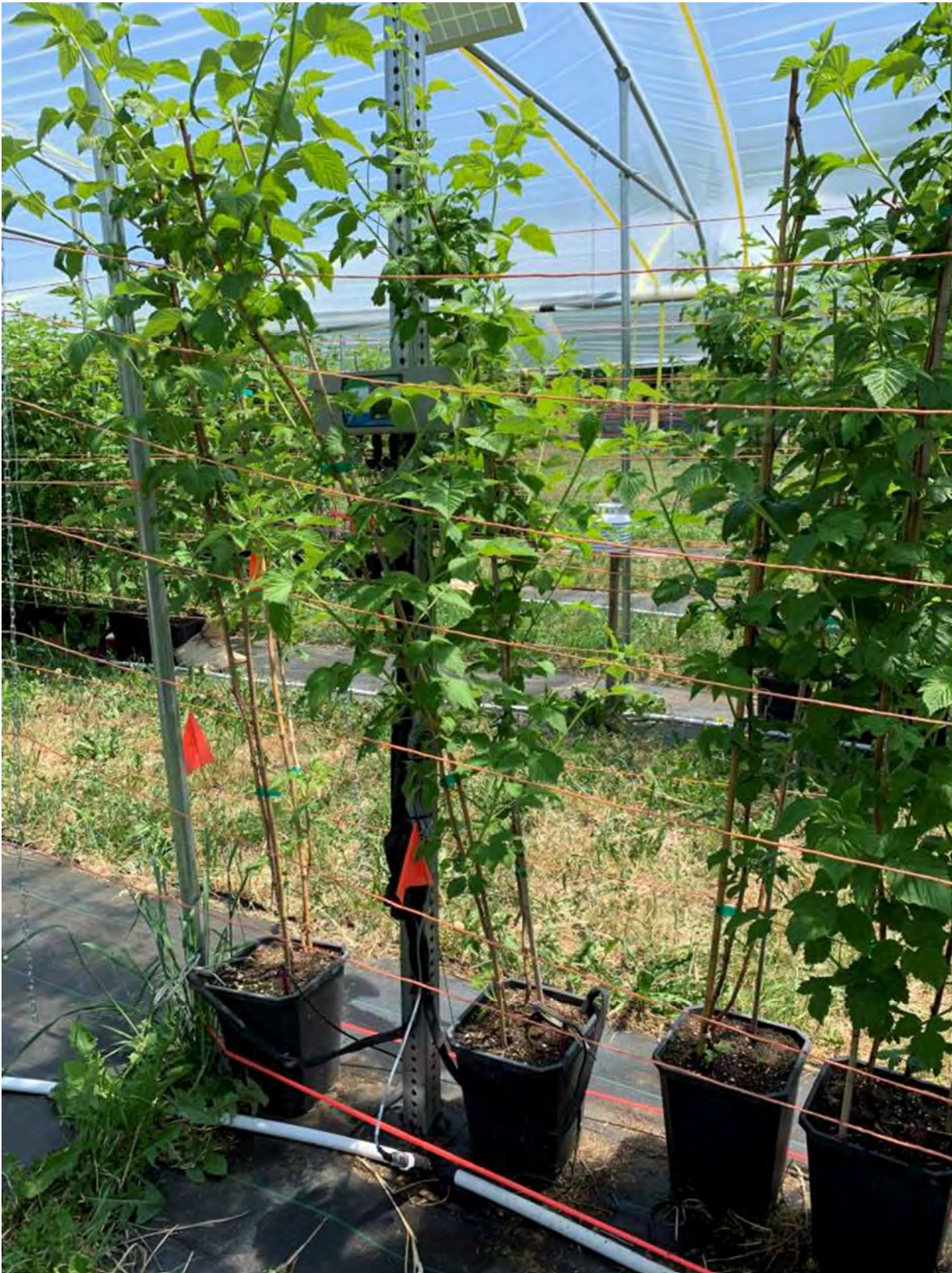
Figure 29. Station ST et capteur de pression (Hortau), framboisiers en pots sous abri
