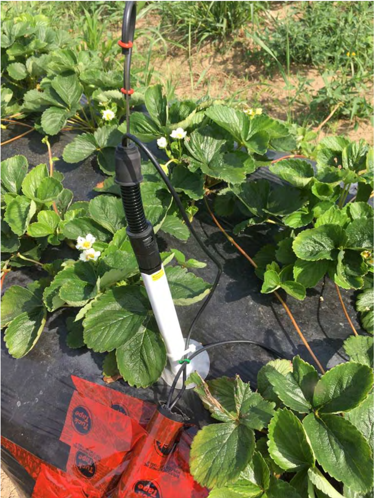
Figure 9. Tensiomètre Teros-32 de Meter (Hoskin Scientifique), fraises sur sol butté recouvert de plastique
