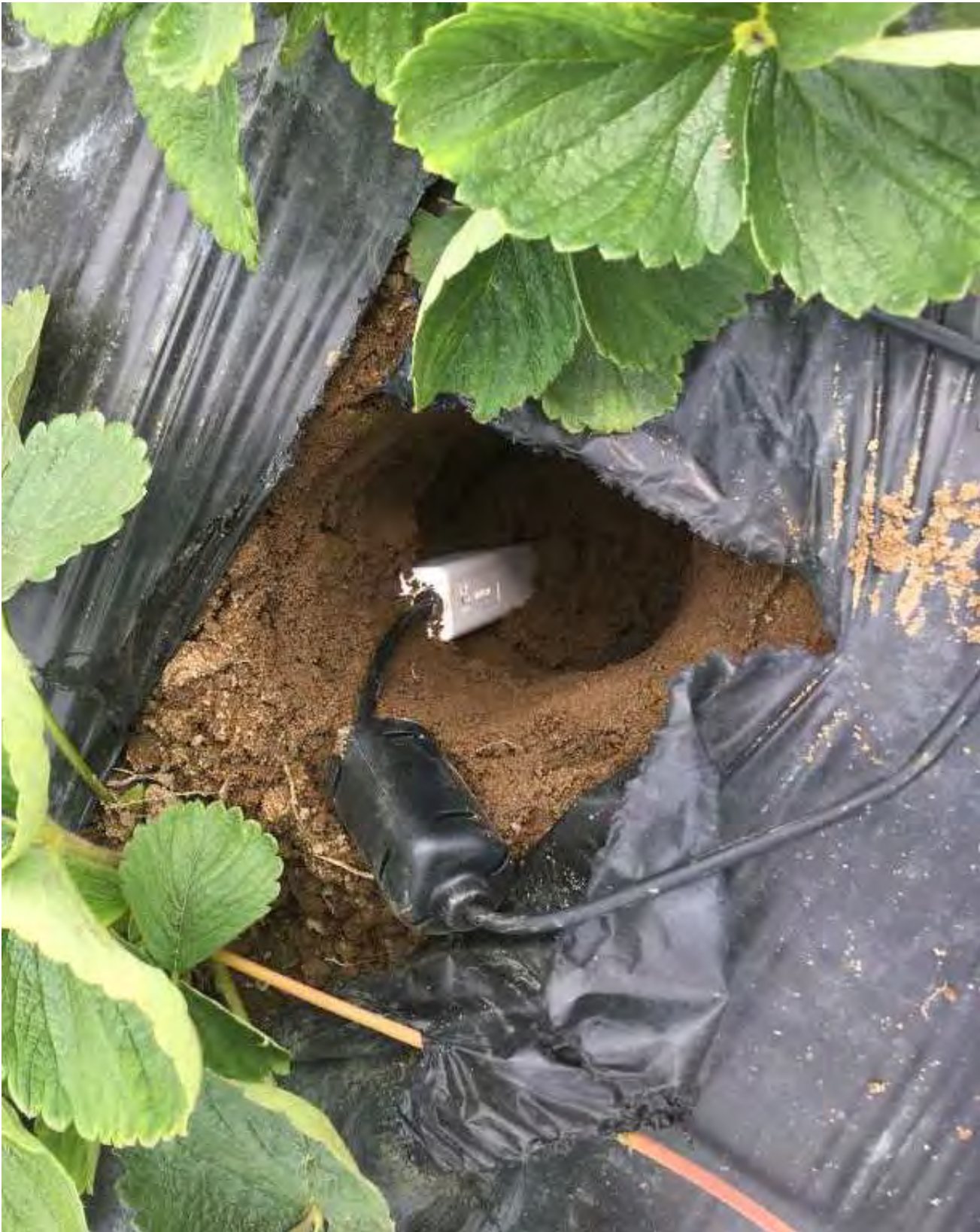
Figure 8. Installation de sonde Teros-12 de Meter (Hoskin Scientifique), fraises sur sol butté recouvert de plastique (installation similaire pour OAD 14 de Dubois Agrinovation)
