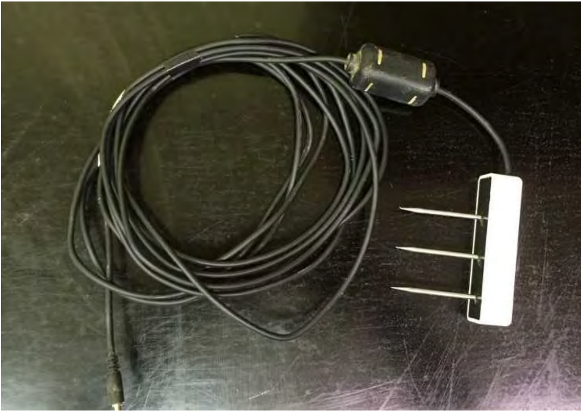
Figure 30. Sonde Teros-12 de Meter (Hoskin Scientifique)
