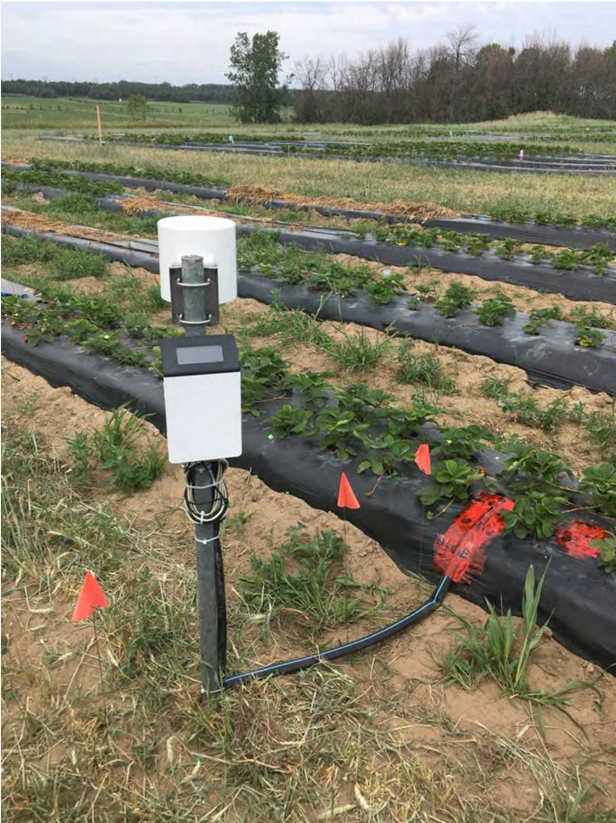
Figure 10. ZL6 de Meter (Hoskin Scientifique), fraises sur sol butté recouvert de plastique
