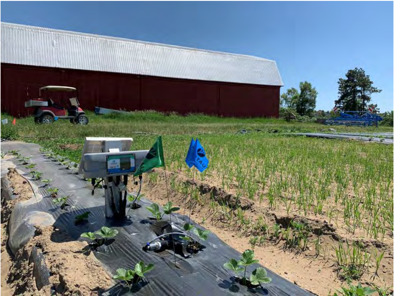
Figure 25. Station ST et capteur de pression (Hortau), fraises sur sol butté recouvert de plastique
