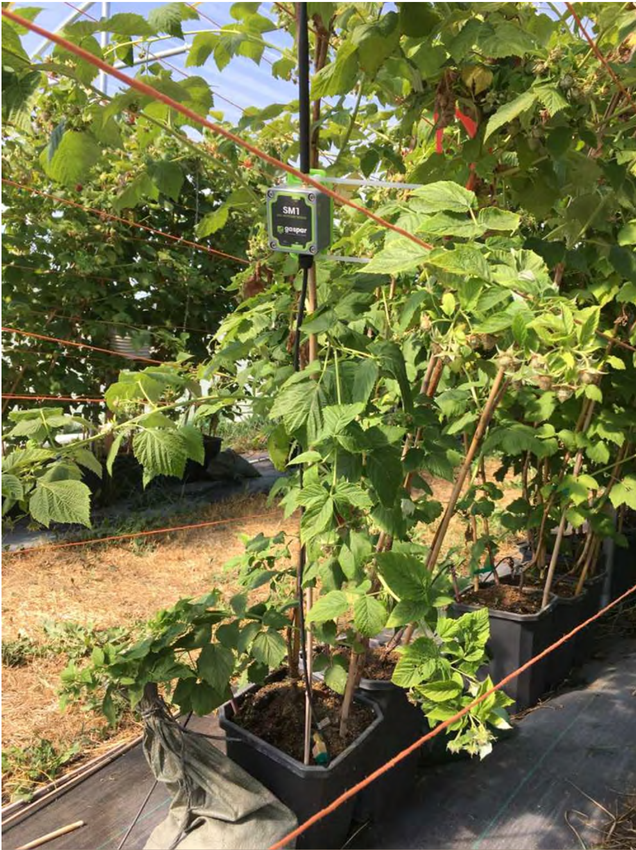
Figure 3. Tensiomètre Irrrometer 4 pouces (Gaspar), framboisiers en pots sous abri
