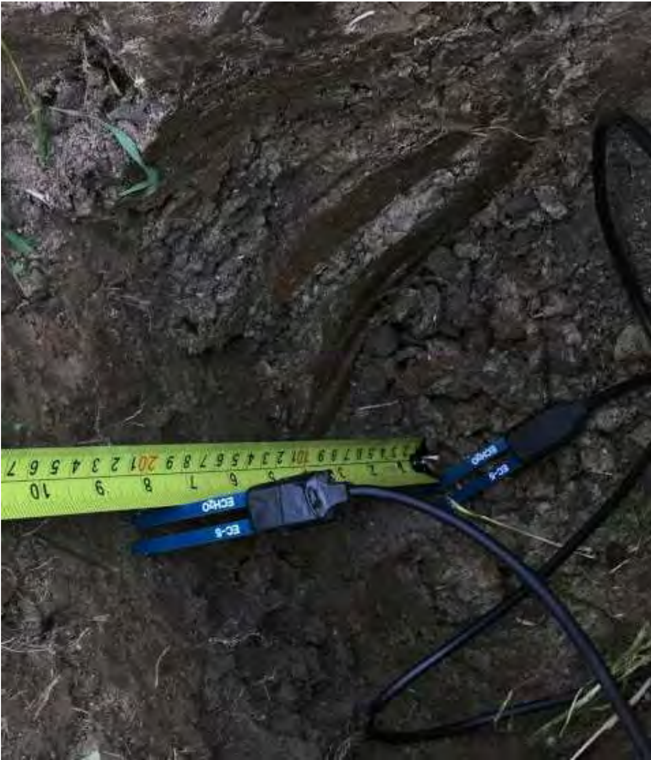
Figure 5. Installation de sonde EC-5 de Meter (Hoskin Scientifique), prairie
