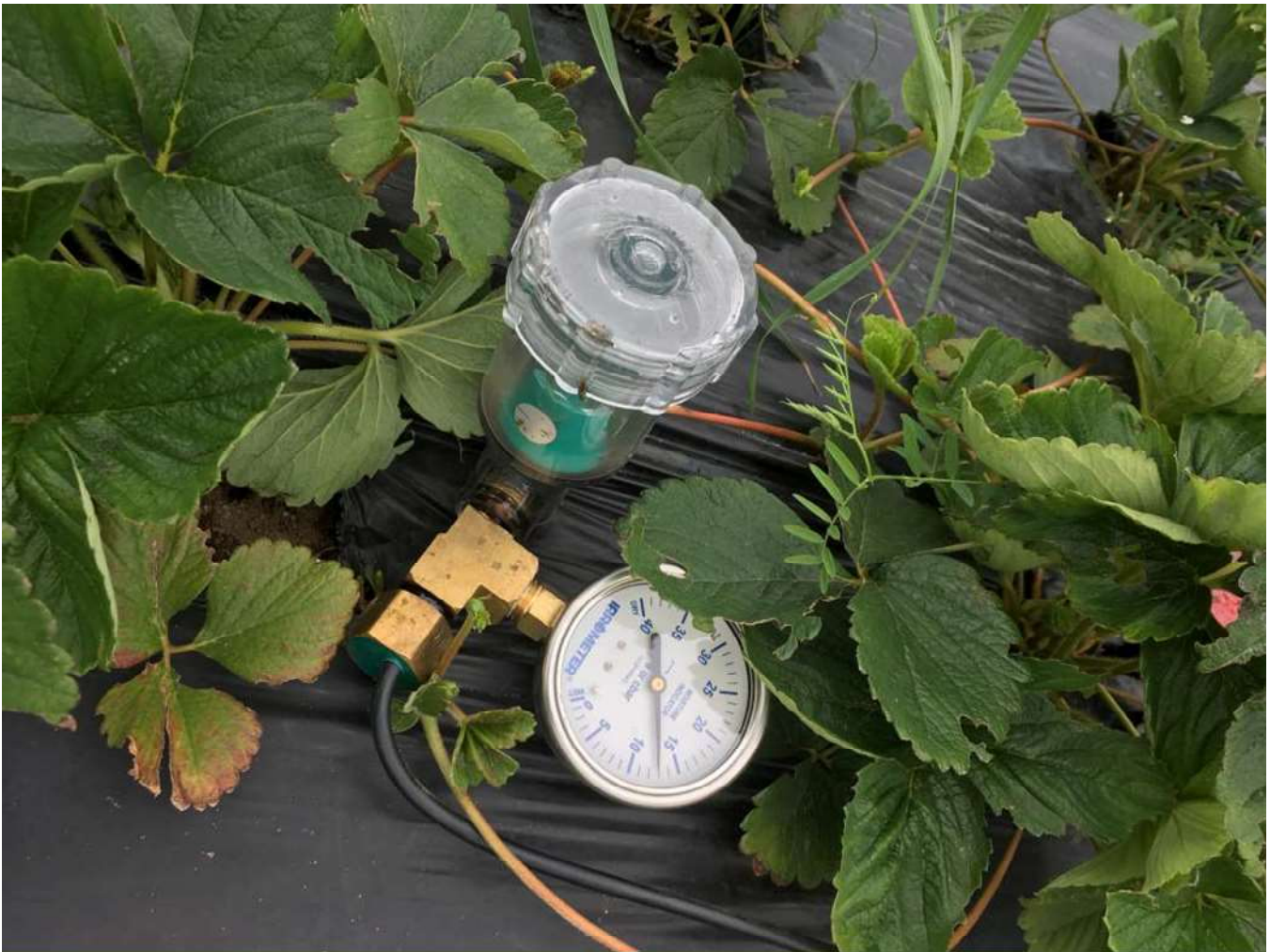
Figure 17. Tensiomètre Irrometer (SimpliCollect), fraises sur sol butté recouvert de plastique
