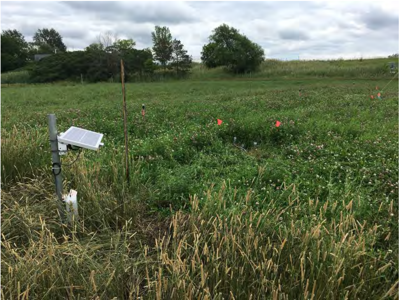
Figure 16. Module et panneau solaire (SimpliCollect), prairie
