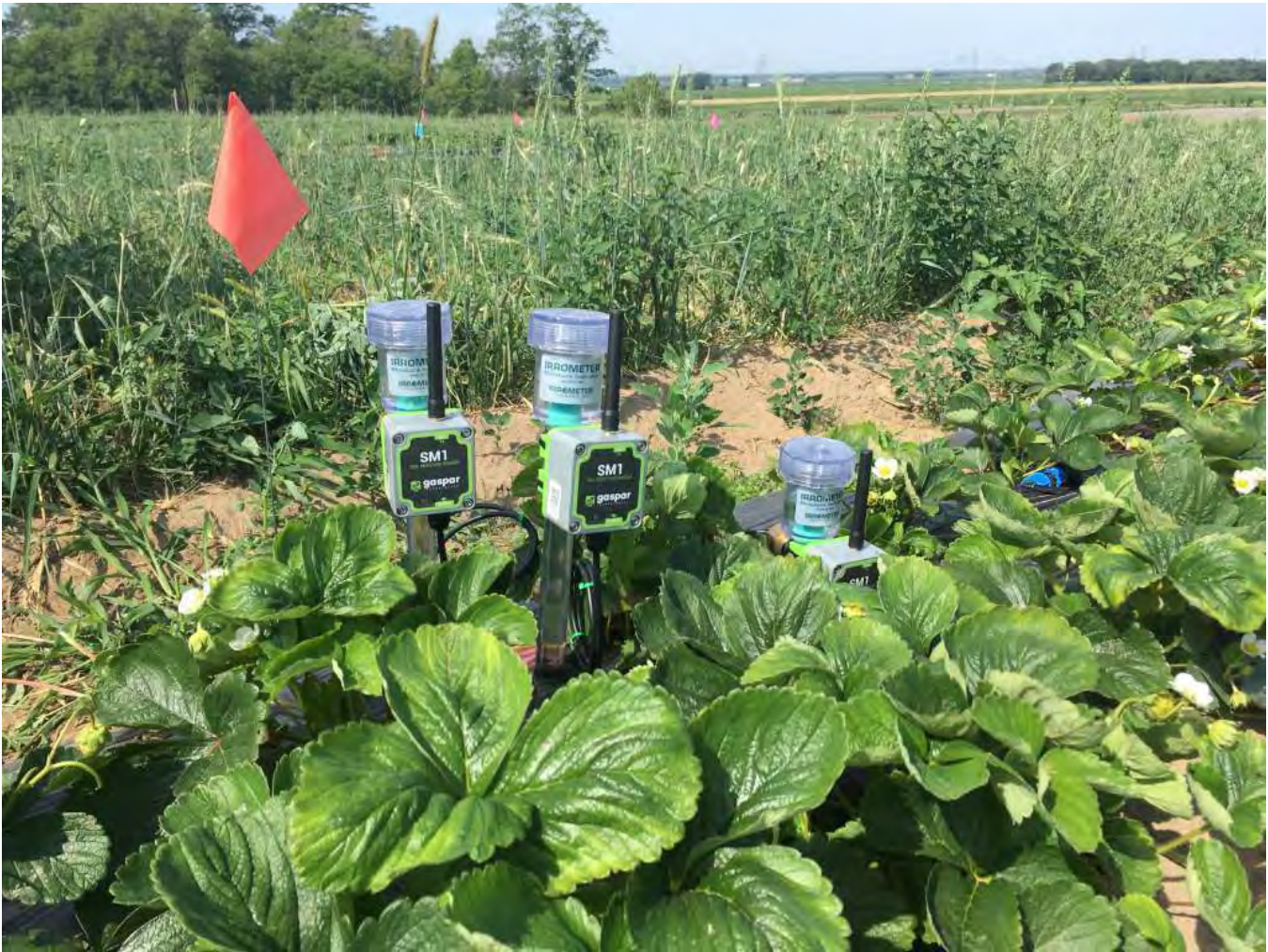
Figure 4. Tensiomètres Irrrometer (Gaspar), fraises sur sol butté recouvert de plastique
