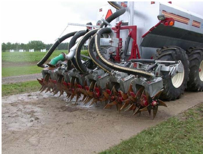
**Figure 3. Dispositif permettant l'incorporation du lisier durant les essais d'été.**
