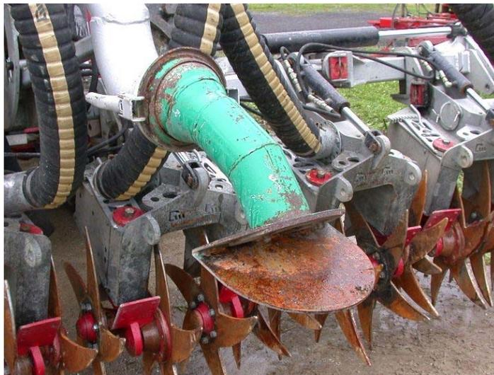
Figure 2. Dispositif permettant l'application de surface du lisier durant les essais d'été.
