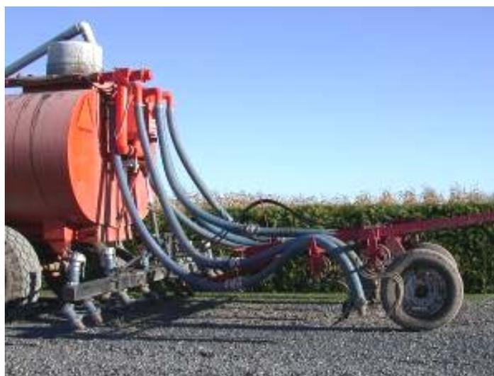
**Figure 10. Réservoir à lisier avec la rampe d'épandage pour l'application de surface et l'outil d'incorporation.**
