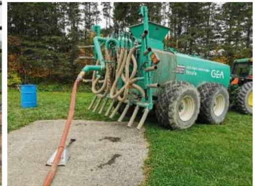
Figure 2 Réservoir de lisier avec boyau d'alimentation
