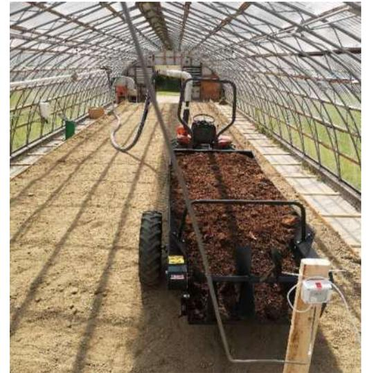
Figure 5 Épandage de fumier avec un épandeur à batteur horizontal
