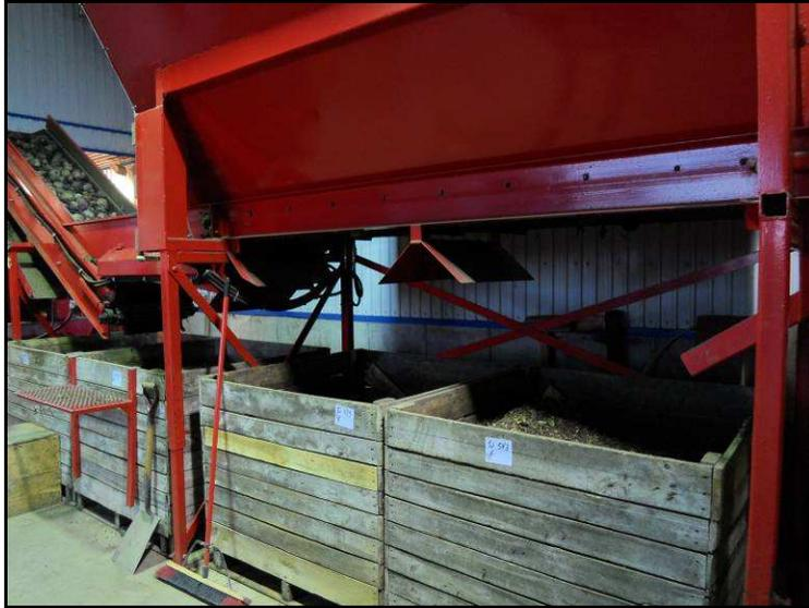
**Figure 10.** Unités de récupération des matières solides sous la trémie d'alimentation, le dessableur et le convoyeur au site 1.
