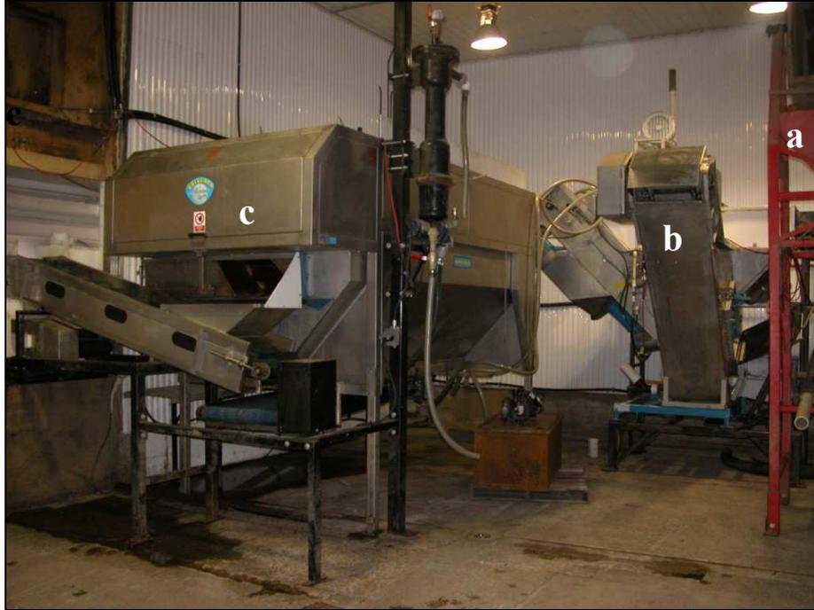
**Figure 27.** Chaîne de lavage au site 3, incluant la trémie d'alimentation (a), le bassin dépierreur (b), et la polisseuse (c).
