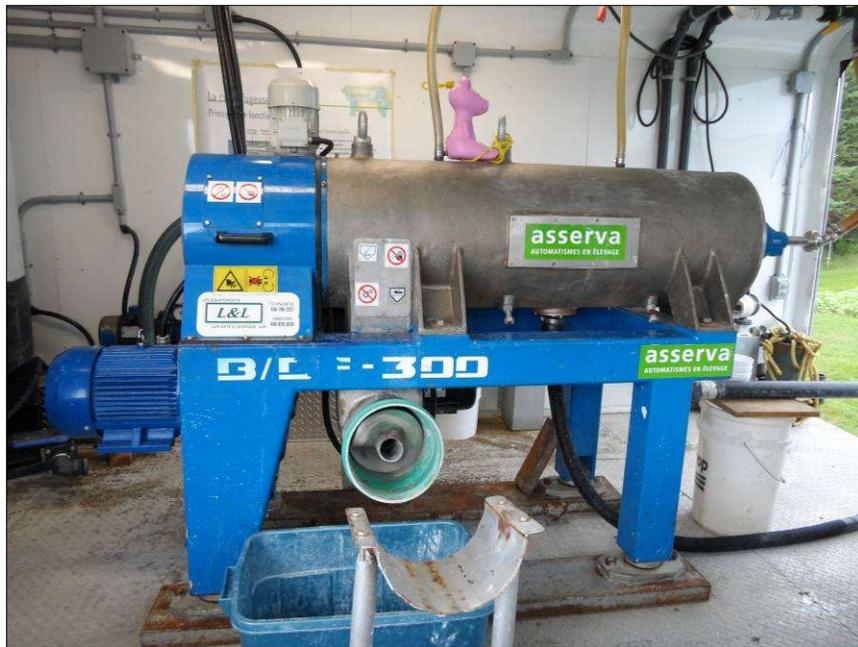
**Figure 7.** Centrifugeuse utilisée pour les essais dans l'eau de lavage de carottes cultivées en sol organique.
