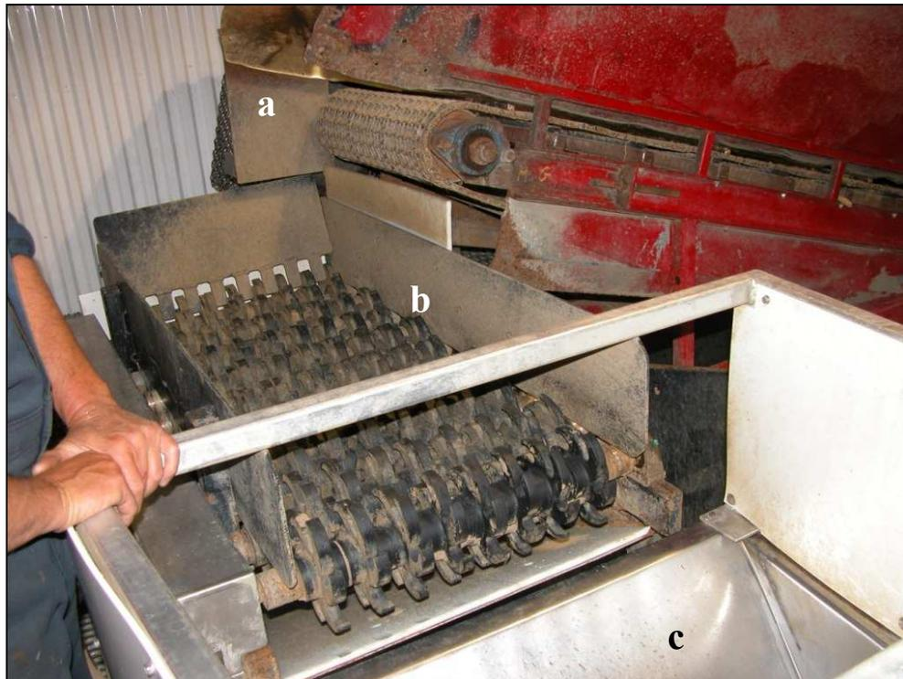
**Figure 28.** Système de dessablage au site 3, incluant le convoyeur (a), le dessableur (b) et le bassin dépierreur (c).
