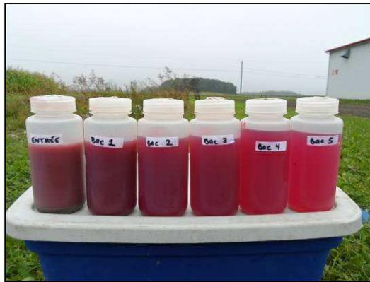
**Figure 14.** Couleur dans les cinq unités de sédimentation après 9 h de pompage d'eau de lavage de betterave rouge au site 1 (échantillonnage du 11 septembre).
