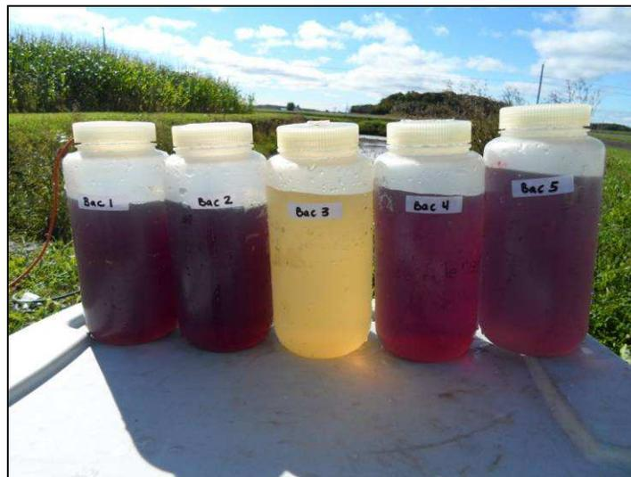
**Figure 15.** Couleur dans les cinq unités de sédimentation après 2 jours de lavage de betterave et 3 jours de lavage de carotte au site 1, le bac 3 était aéré au taux de 0,009 L<sub>air</sub>/L<sub>eau</sub>-min depuis 36 h sans nouvelle entrée d'eau (échantillonnage du 16 septembre).
