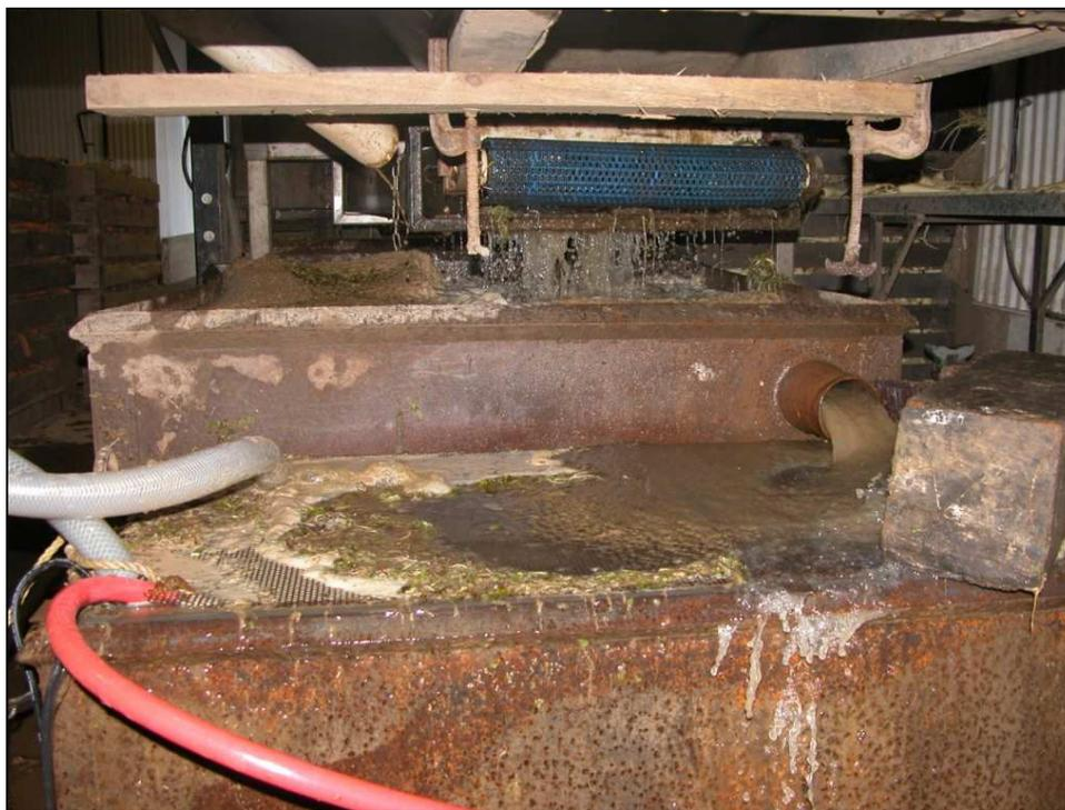
**Figure 29.** Réservoir surmonté d'une plaque perforée sous la polisseuse au site 3.
