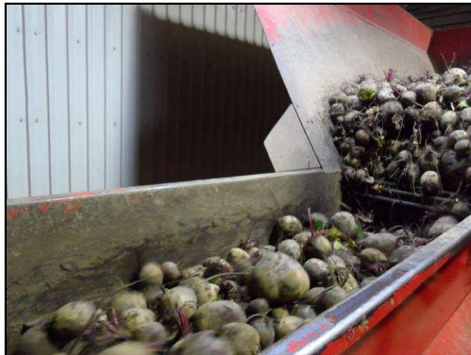
**Figure 9.** Trémie d'alimentation et dessableur en opération au site 1.
