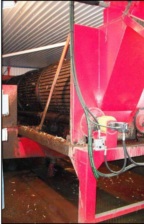
**Figure 8.** Laveuse de type baril rotatif en opération au site 1.
