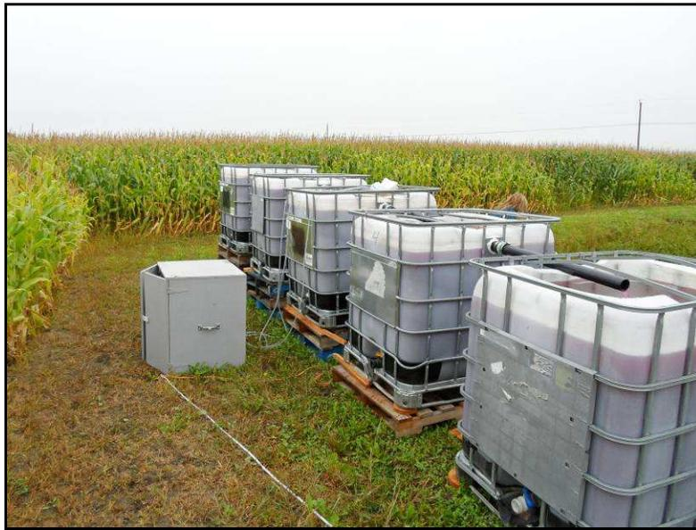
**Figure 12.** Unités de sédimentation et système d'aération installé au site 1.
