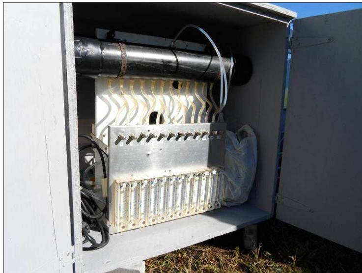
**Figure 5.** Système d'aération avec débitmètres utilisé pour tous les essais.
