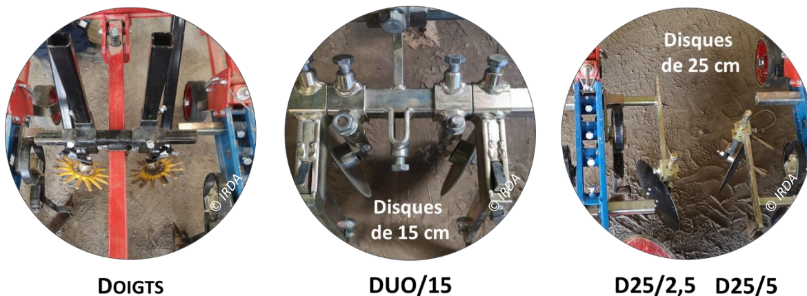
Figure P-2.2.1. Outils utilisés pour renchausser de la carotte.
