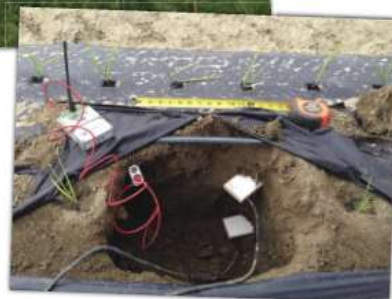
TENEUR EN EAU ET TENSION DU SOL (tensiomètre et sondes TDR)
