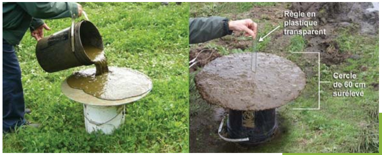
Prise de la mesure d'affaissement
