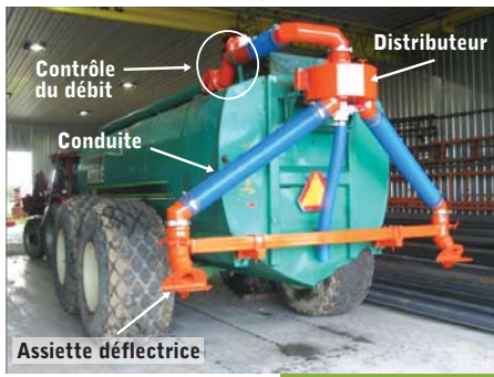
Rampe basse de type « pleine terre »
