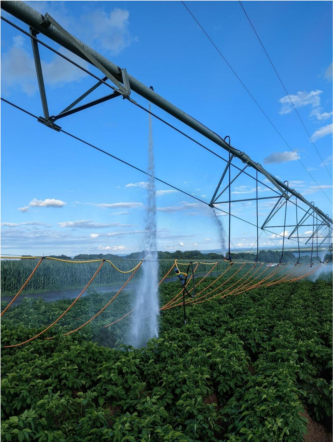
Figure 23. Bris mécanique d'un pendillard du pivot.
