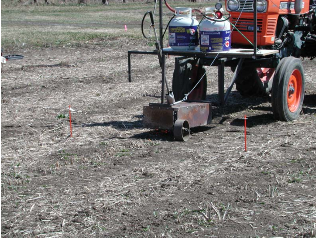
Figure 1. Prototypé de pyrodésherbeur à flamme couverte en action dans l'aspergeraie.
