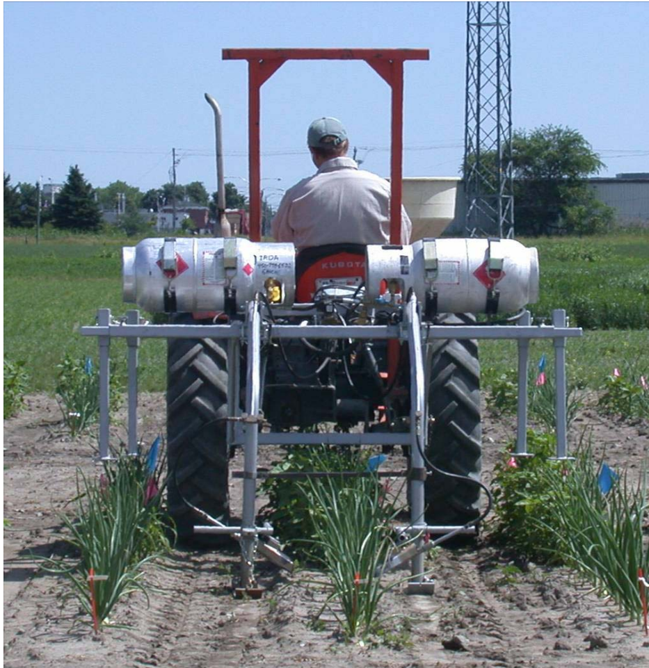
Figure 3. Photo montrant le pyrodésherbeur à flamme nue dans l'oignon espagnol.
