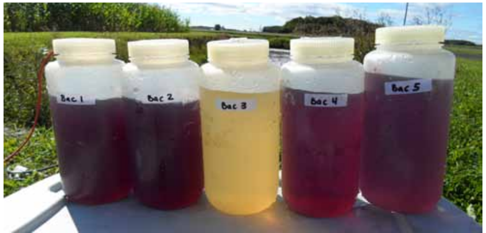
Échantillons prélevés dans les unités de sédimentation après 36 heures sans nouvelle entrée d'eau. L'unité 3 a été aérée en continu.
