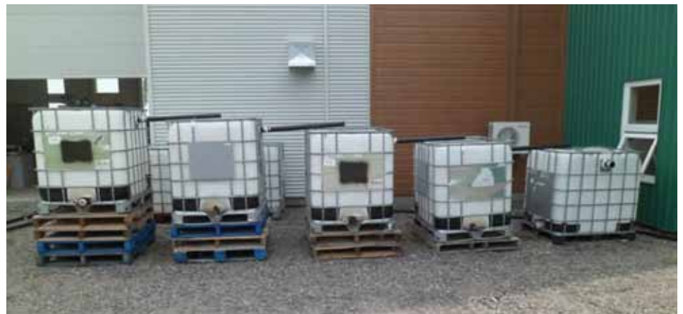
Unités de sédimentation utilisées pour les essais en entreprises.
