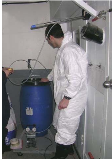
Figure 11 : Échantillonnage de l'air pour l'analyse d'odeur
