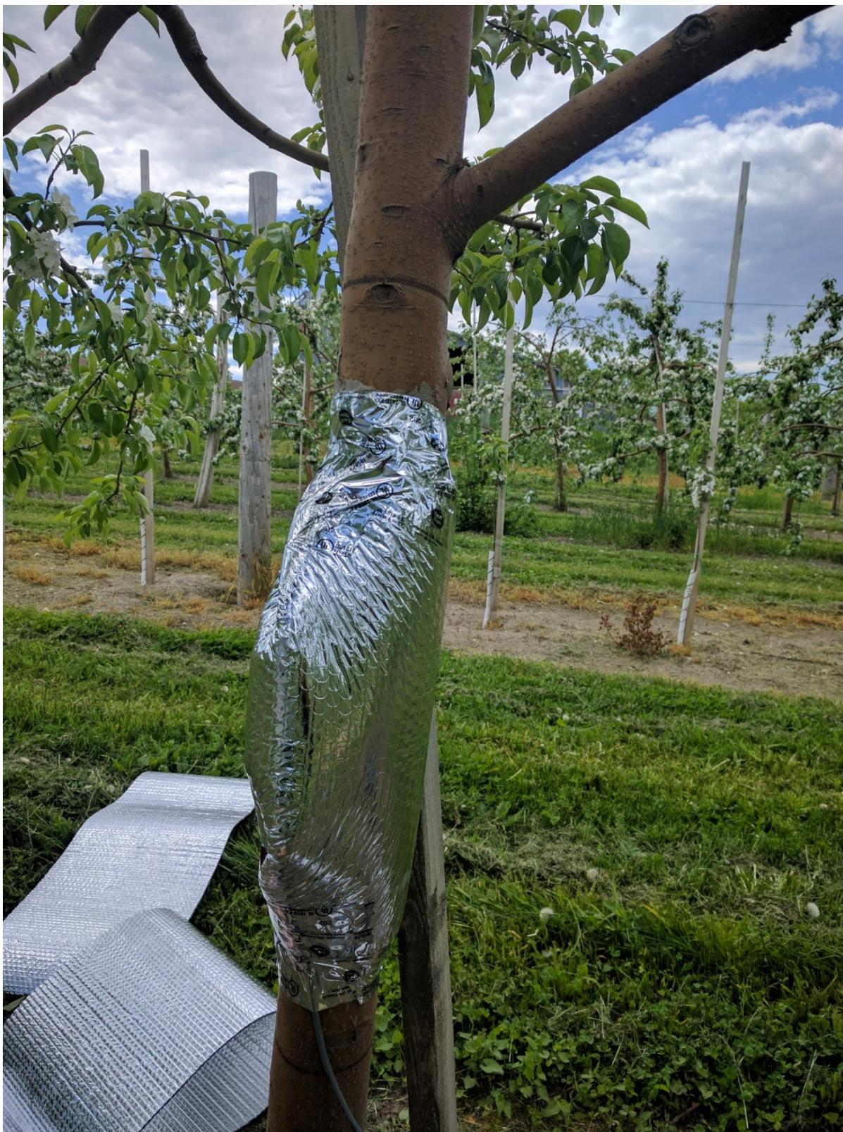
Figure 20. Étanchéisation et isolation thermique des sondes à dissipation thermique.
