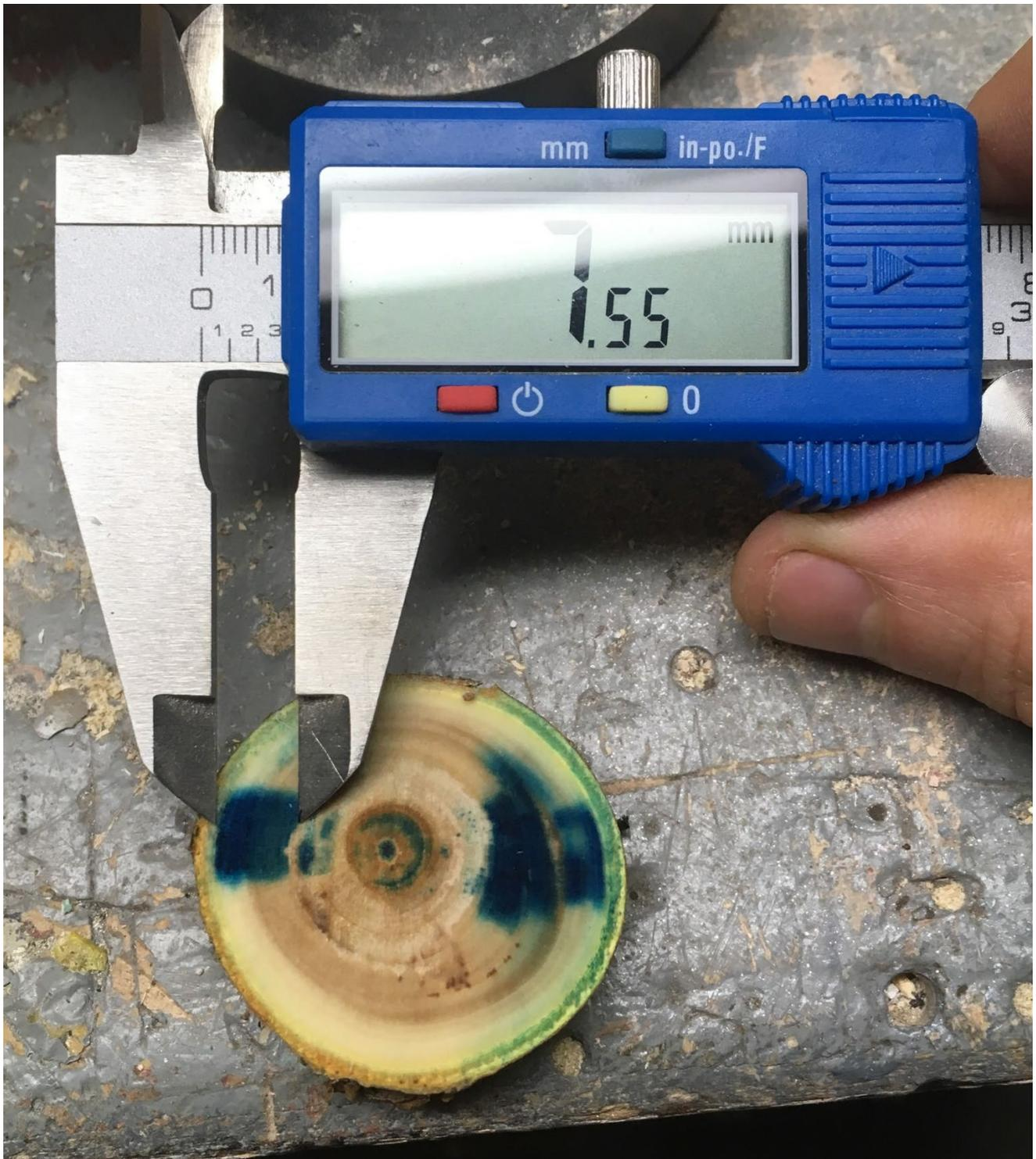
Figure 23. Mesure de l'épaisseur de l'aubier coloré.
