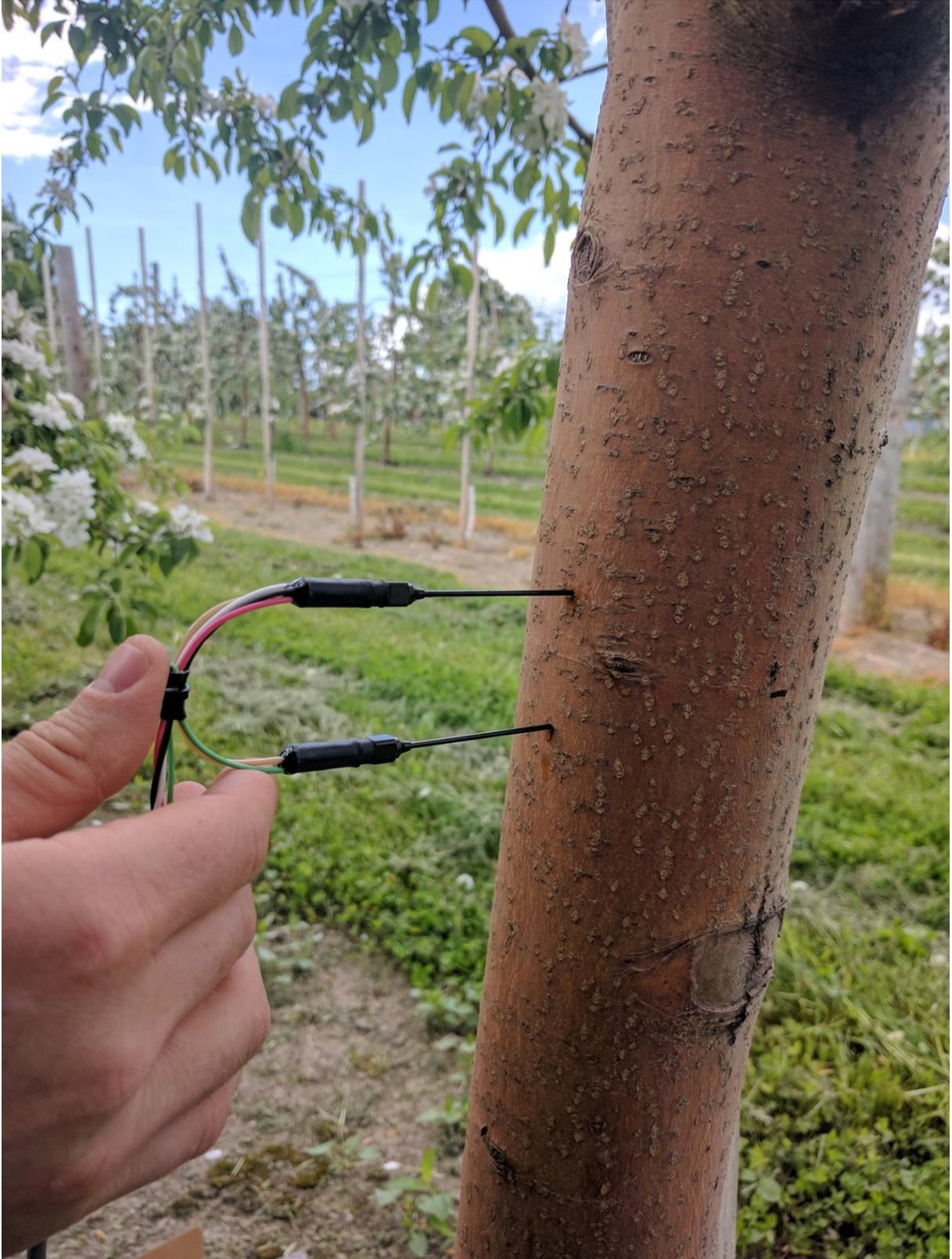
Figure 19. Insertion des sondes à dissipation thermique dans le tronc d'un pommier.
