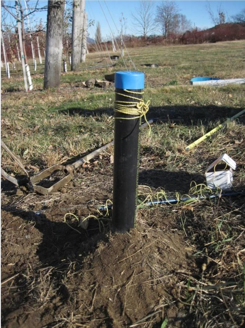
Figure 9. Piézomètre installé pour suivre l'évolution de la hauteur de la nappe d'eau.
