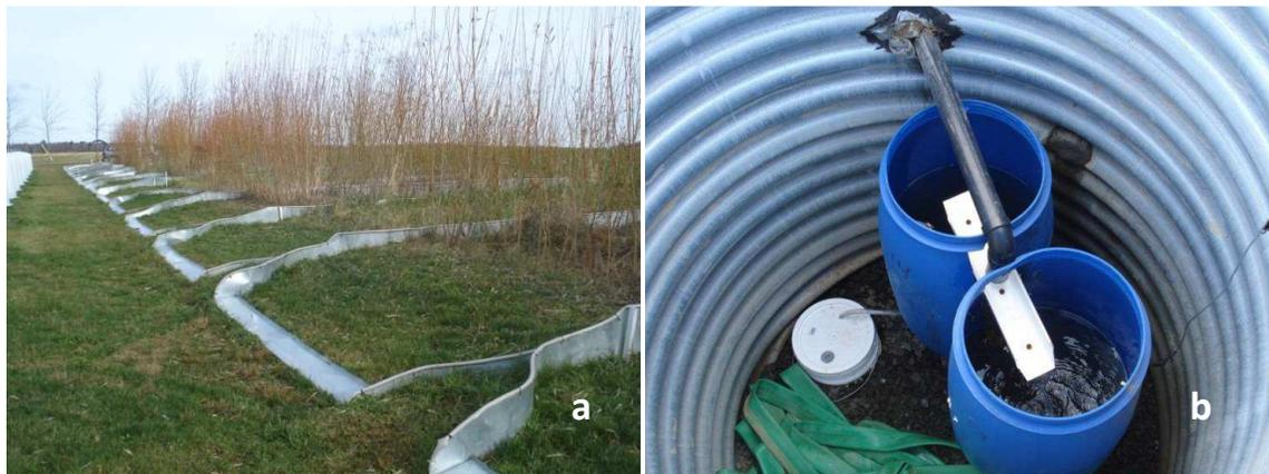
Figure 8. Dalles installées à la sortie des bandes végétatives filtrantes (a) pour canaliser l'eau vers les dispositifs de mesure et d'échantillonnage des volumes d'eau ruisselés (b).
