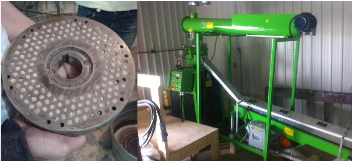
Figure 4. Matrice perforée 6mm et granulater.
