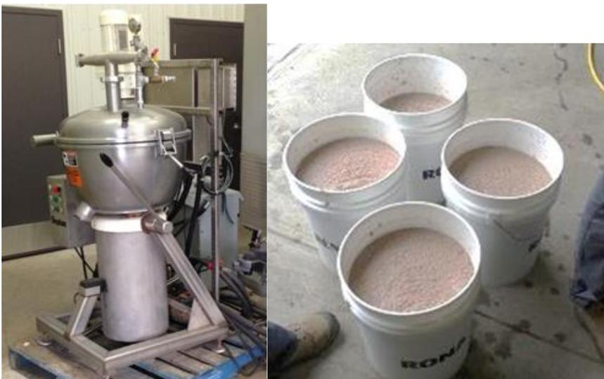
Figure 1. Broyeur Stephan UM 80 et bouillie (Br) de Pdt récupérée.
