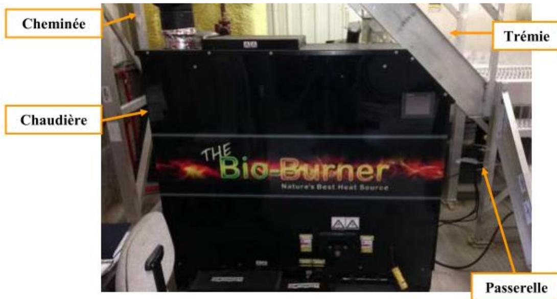
**Figure 6. Chaudière (Bio-Burner BB-100) dans la salle des tests de combustion de l'IRDA.**
