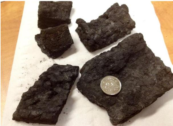
**Figure 49. Échantillon de mâchefers retrouvés suite à la combustion des granules de Pdt déclassées.**
