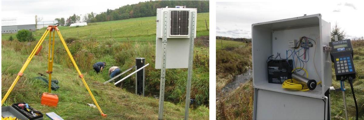
**Figure 8. Dispositif d'alimentation solaire et d'enregistrement électronique des mesures provenant des sondes à la station hydrométrique du ruisseau Brook.**
