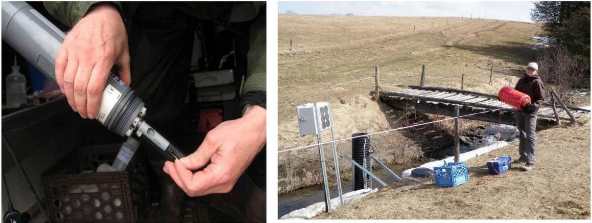
Figure 7. La sonde multi-paramètres (vue rapprochée) installée avec un dispositif de flottaison dans le tube de plastique perforé de pvc (en noir) à la station hydrométrique du ruisseau Cass.
