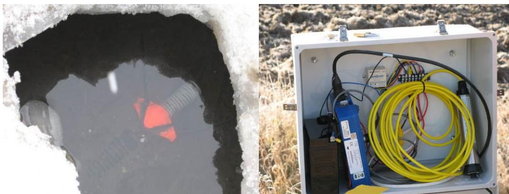
**Figure 9. Les sondes barométriques et acoustiques installés dans le cours d'eau permettent la mesure en continu du niveau d'eau et de la vitesse du courant toute l'année.**
