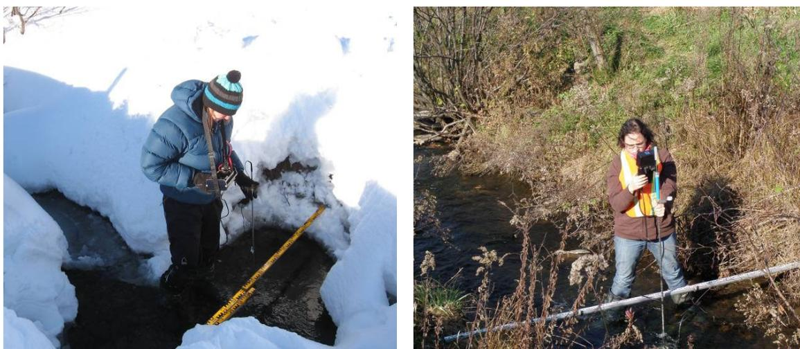
**Figure 10. Mesure du débit à l'aide du moulinet hydrométrique.**
