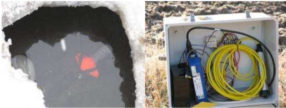
Photo 4. Le limnimètre et la sonde acoustique installés dans le cours d'eau permettent la mesure en continu du niveau d'eau et de la vitesse du courant toute l'année.
