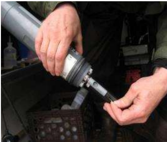
Photo 2. La sonde multi-paramètres (vue rapprochée) qui sera installée, avec un dispositif de flottaison, dans le tube de plastique perforé de pvc (en noir).
