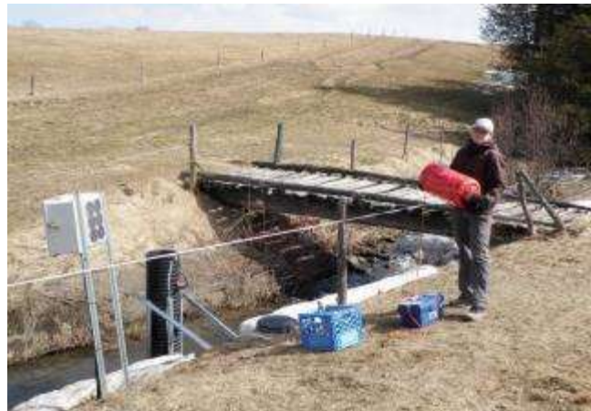
Photo 2. La sonde multi-paramètres (vue rapprochée) qui sera installée, avec un dispositif de flottaison, dans le tube de plastique perforé de pvc (en noir).
