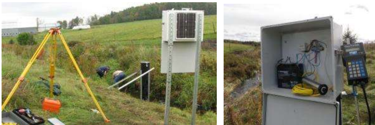
Photo 3. Dispositif d'alimentation solaire et d'enregistrement électronique des mesures provenant des sondes, installé sur la rive.
