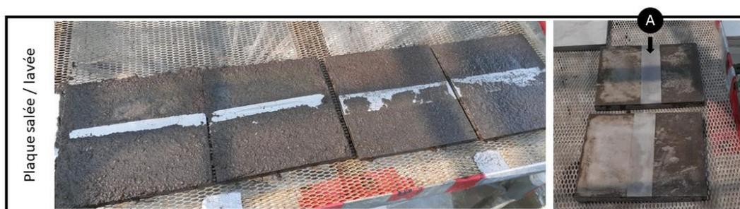
**Figure 7.** Souillage des plaques en béton coulé sur place pour le test de Crystal violet. La lettre A indique la zone où le ruban a été utilisé.
