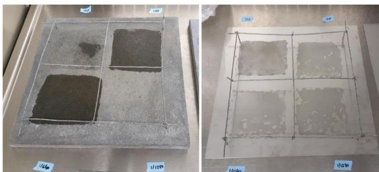
**Figure 4.** Application de 1 ml de lisier sur la plaque couvrant une aire de 100 cm<sup>2</sup>
