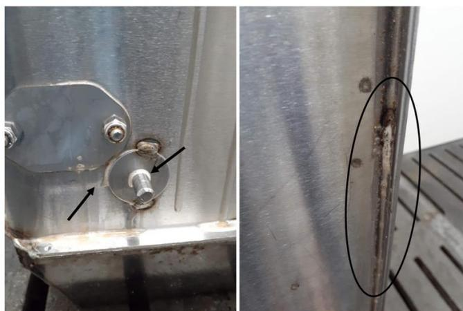
**Figure 18.** La présence de bulles dans le coin (droit) et la structure d'assemblage (gauche) après application de Biofinder
