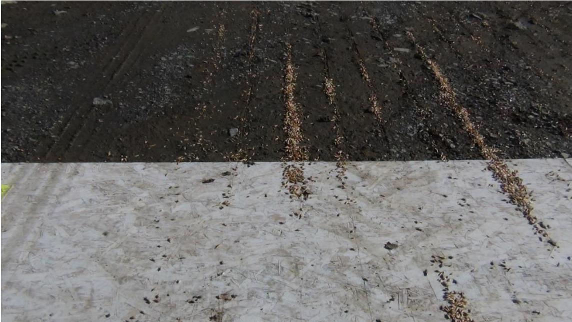
Il devient évident qu'une intervention avec un agent de fluidité est nécessaire pour réguler l'écoulement de la semence du semoir et en uniformiser le débit à vitesse de 3 et 6 km/hr. Ajoutons, que cette dernière option serait également d'intérêt à la vitesse d'avancement du semoir de 9 km/hr; car le maintien de cette cadence, lors du semis d'épeautre, est peu réaliste.
