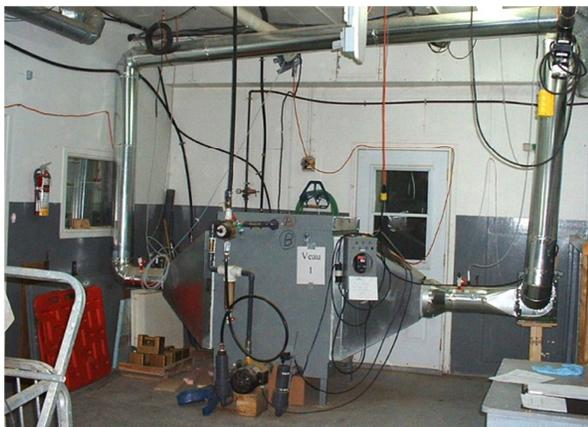
Figure 1. Une des six unités de traitement de l'air à échelle réduite.
