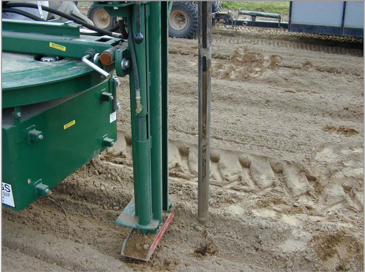
**Figure 28.** Échantillonneur de sol de marque *Giddings* dans les parcelles du dispositif de Deschambault, 19 octobre 2007.
