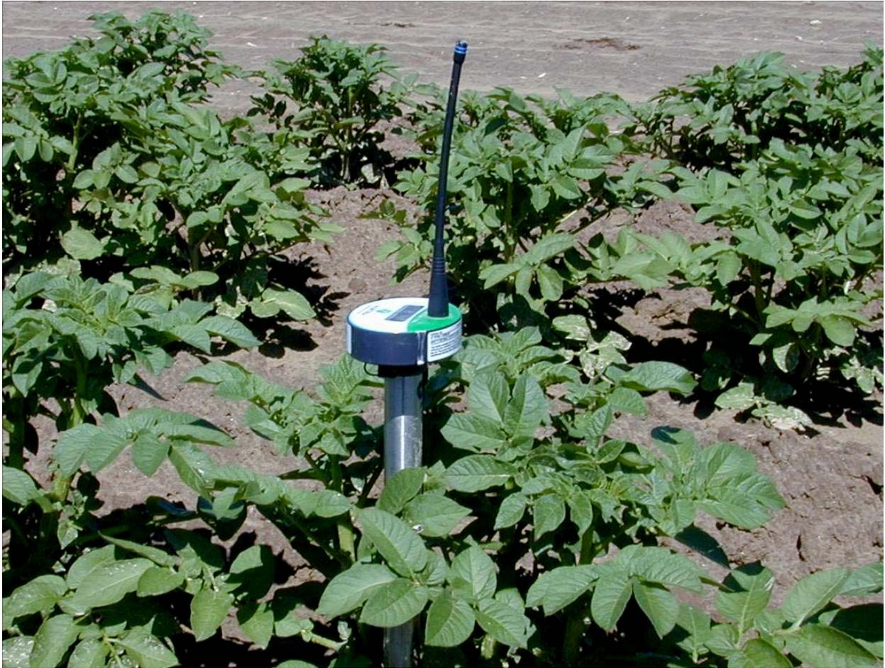
**Figure 26.** Tensiomètre (Hortimètre) installé dans la zone racinaire.
