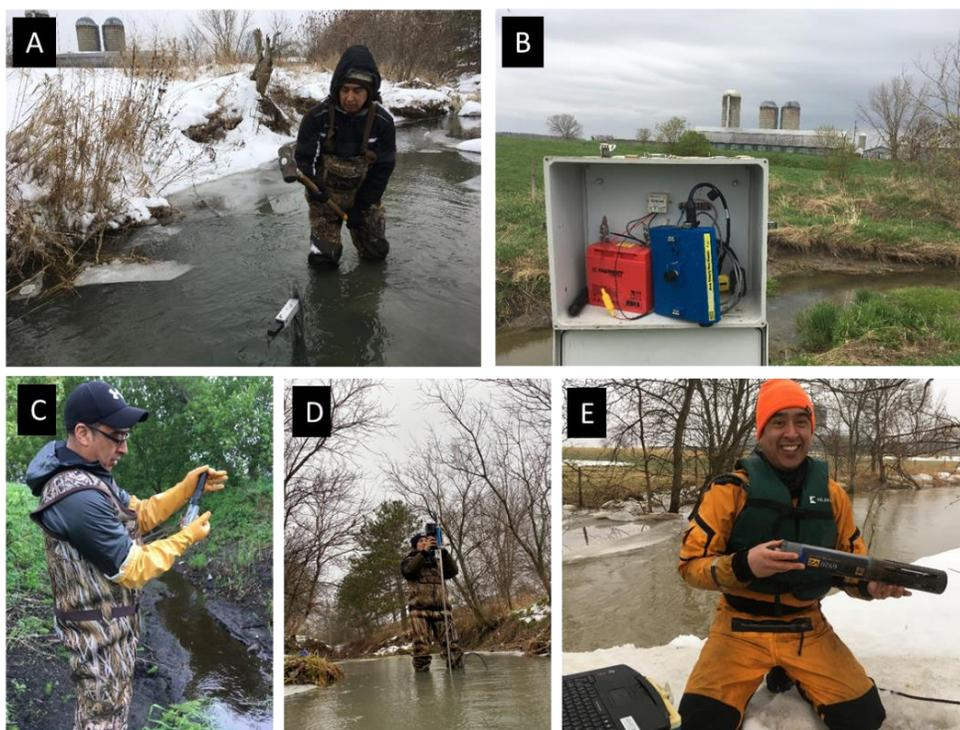
**Figure 3-1** Installation de la sonde ISCO au centre du cours d'eau (A), système d'alimentation sur la rive (B), récolte de données d'une sonde HOBO (C), mesures au Flowtracker (D) et sonde YSI (E).
