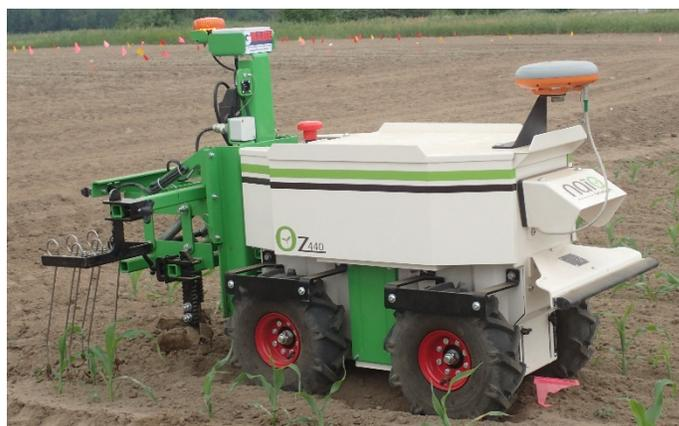
De petite taille, Oz mesure 47 cm de large avec une hauteur de 83 cm, une longueur de 1,3 m (sans les outils de binage) et pèse 150 kg.
