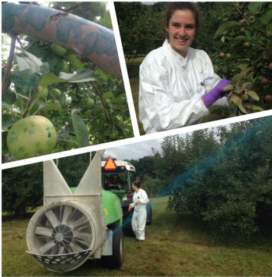
Objectif 2. Colorant alimentaire bleu ajouté aux bouillies et calibration du pulvérisateur conventionnel.
