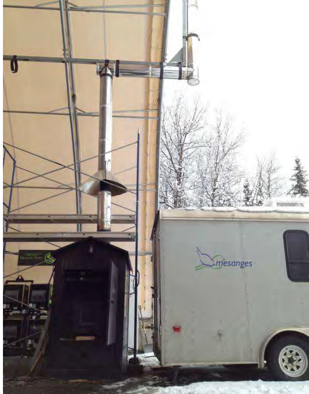
Figure 20. Système de combustion (à gauche) de moyenne capacité (293 kW) et laboratoire d'analyse des gaz où est installé le système de caractérisation des effluents gazeux de l'IRDA (roulotte à droite)
