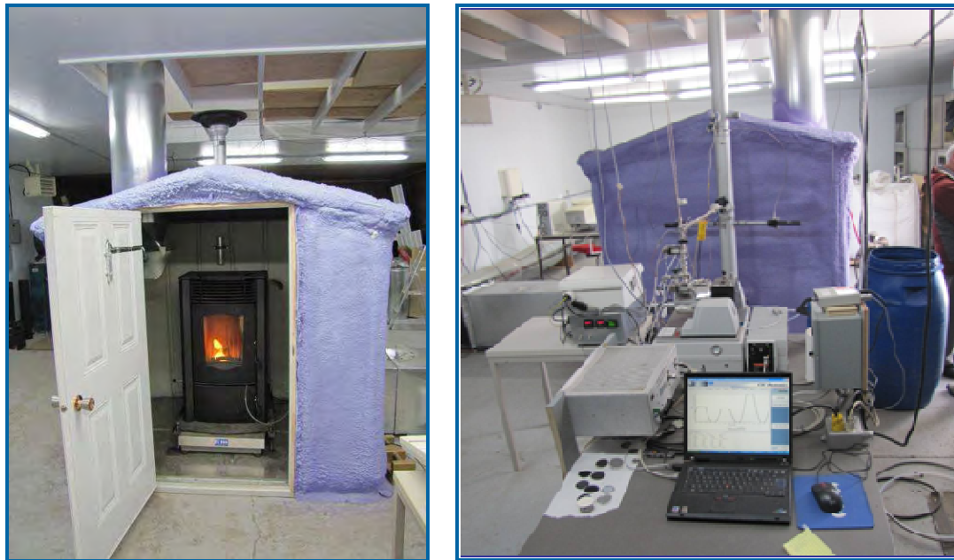
a. Poêle et chambre calorimétrique
