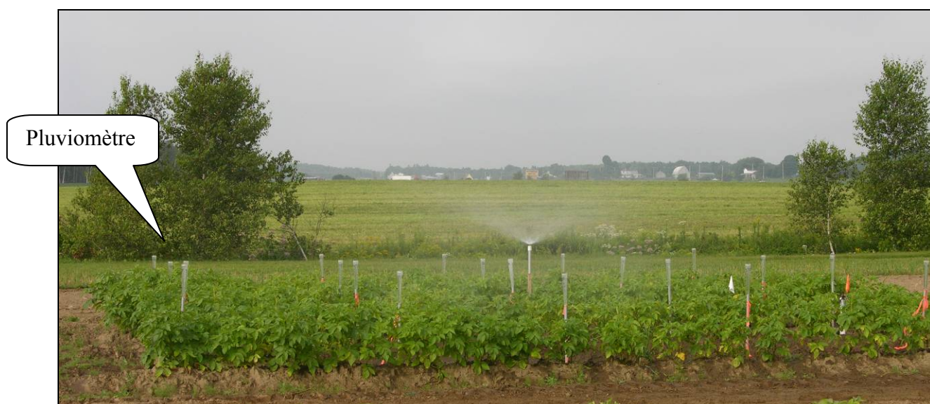
Figure 49. Irrigation et pluviomètres (20) pour mesurer l'uniformité d'application.
