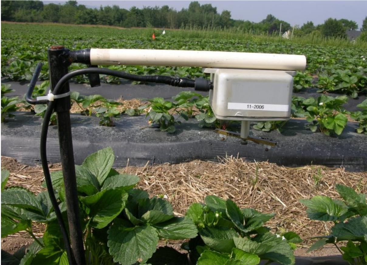
**Figure A-2.** Capteur de spore.
