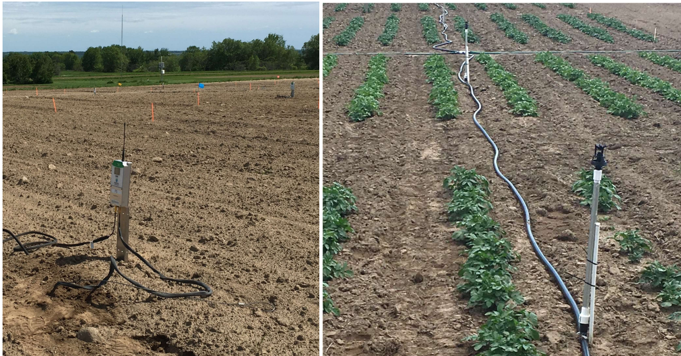
Figure 3. Appareil TX3 d'Hortau muni de trois sorties permettant de suivre en continu le statut hydrique du sol et la température à deux profondeurs (gauche) et gicleurs pour irrigation par aspersion (droite).
