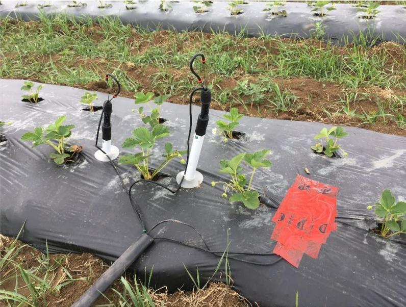
**Figure 10. Tensiomètre Teros-32 de Meter (Hoskin Scientifique), fraises sur sol butté recouvert de plastique**
