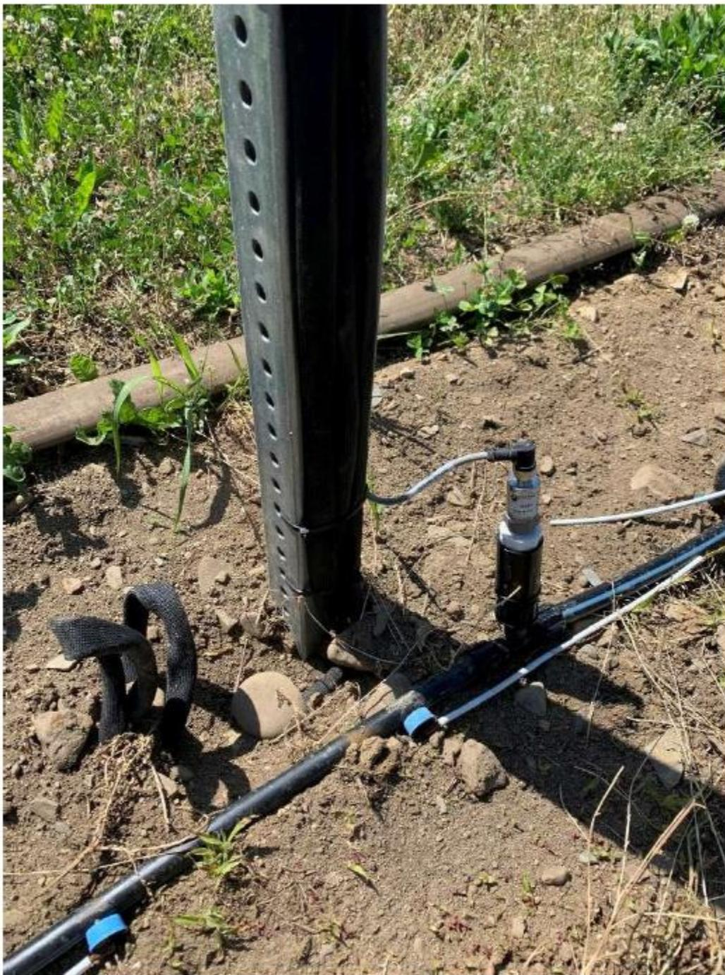
Figure 27. Capteur de pression (Hortau), verger
