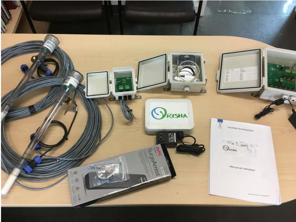
Figure 13. Tensiomètres Irrometer, contrôleur, boîtiers (Orisha), framboisiers en pots sous abri
