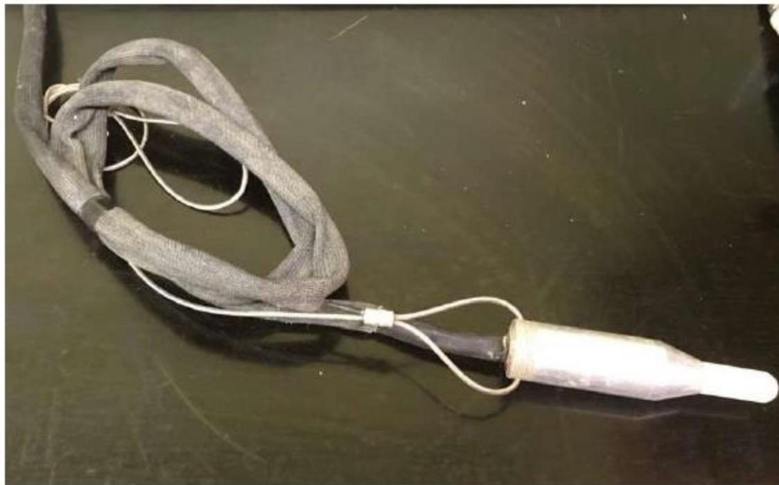
Figure 32. Tensiomètre (Hortau)
