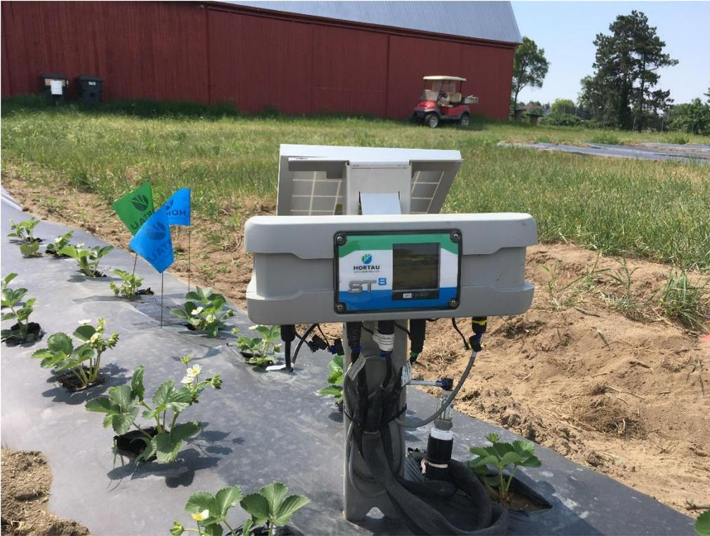
Figure 17. Station ST, tensiomètres (enfouis) et capteur de pression (Hortau), fraises sur sol butté recouvert de plastique
