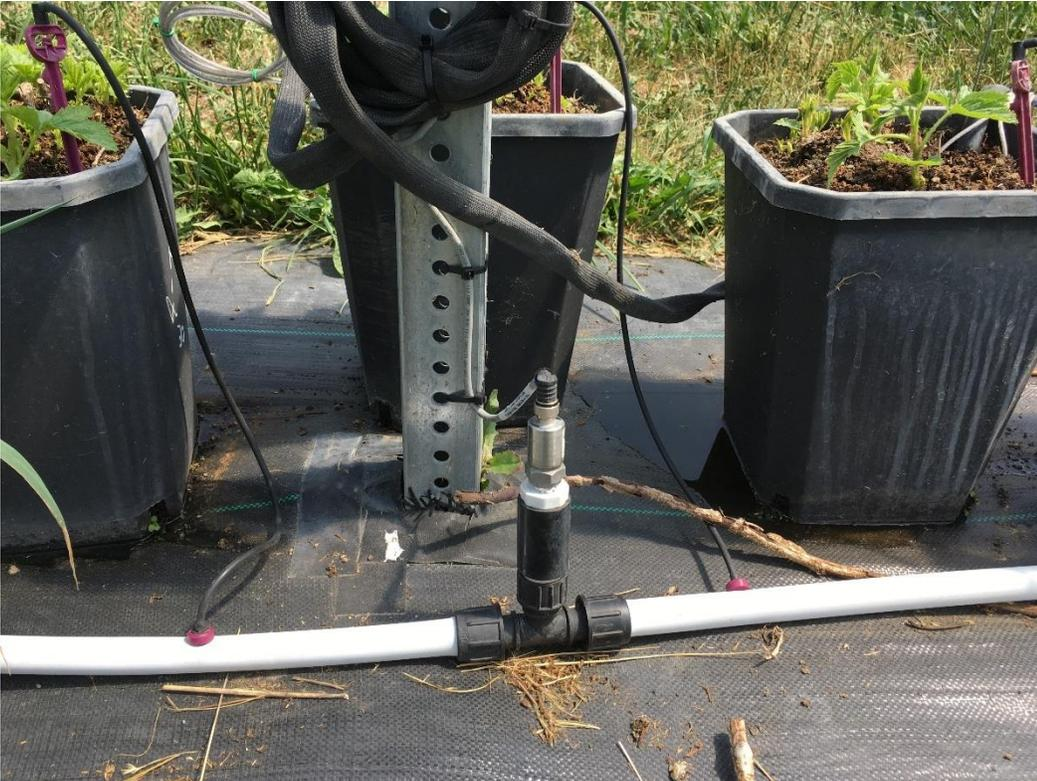
Figure 24. Capteur de pression et tensiomètres (enfouis) (Hortau), framboisiers en pots sous abris
