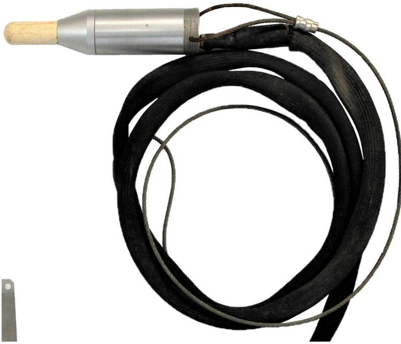
Figure 27. Tensiomètre (Hortau)
