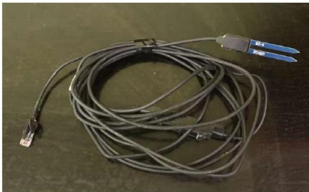
Figure 31. Sonde EC-5 de Meter (Hoskin Scientifique)
