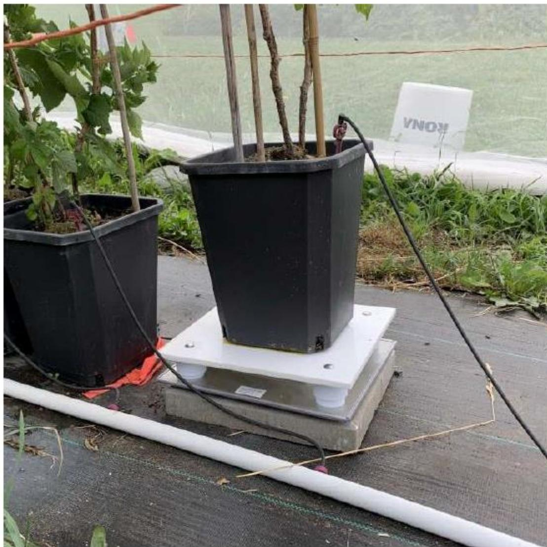
Figure 20. Balance (SimpliCollect), framboisiers en pots sous abri
