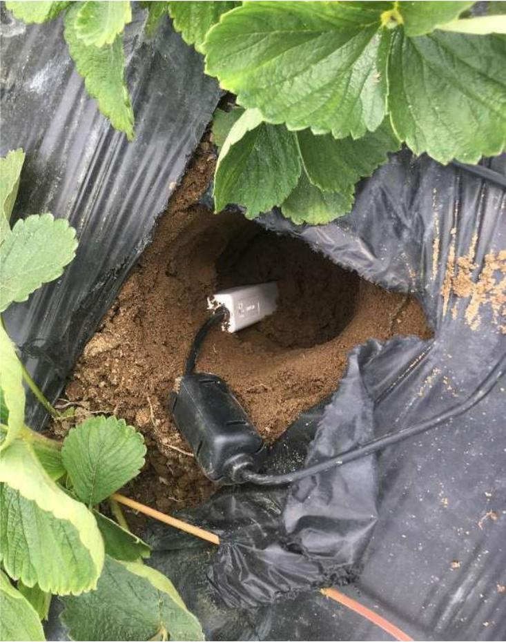
**Figure 9. Installation de sonde Teros-12 de Meter (Hoskin Scientifique), fraises sur sol butté recouvert de plastique**
