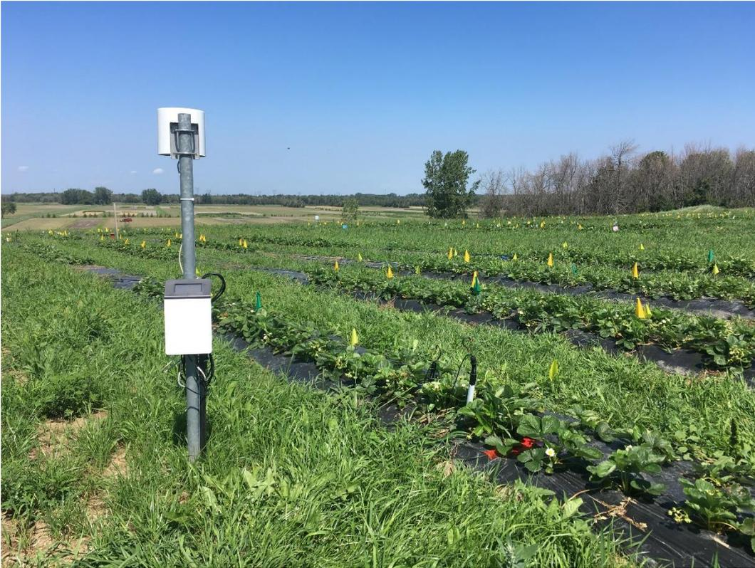
Figure 11. ZL6 de Meter (Hoskin Scientifique), fraises sur sol butté recouvert de plastique
