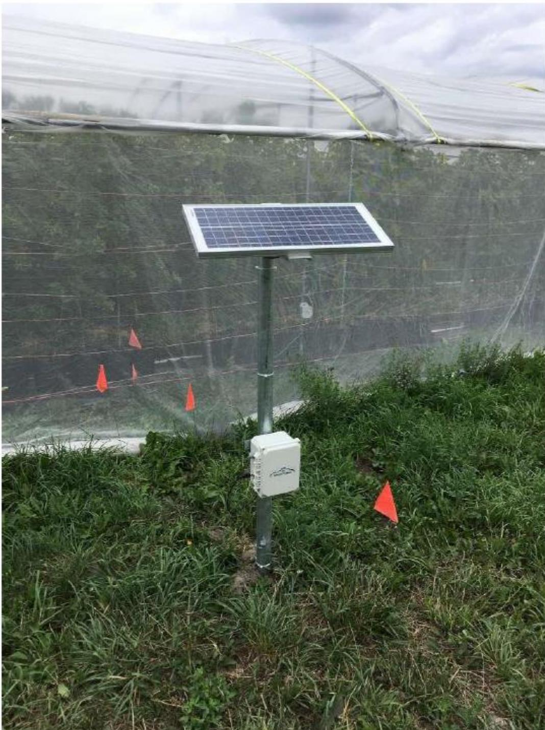
Figure 19. Module et panneau solaire (SimpliCollect), framboisiers en pots sous abri
