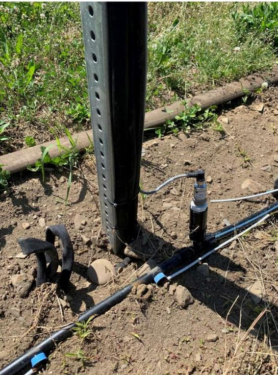
Figure 20. Capteur de pression (Hortau) et tensiomètres (enfouis), verger de pommiers
