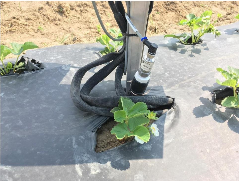
Figure 18. Capteur de pression et tensiomètres (enfouis) (Hortau) fraises sur sol butté recouvert de plastique
