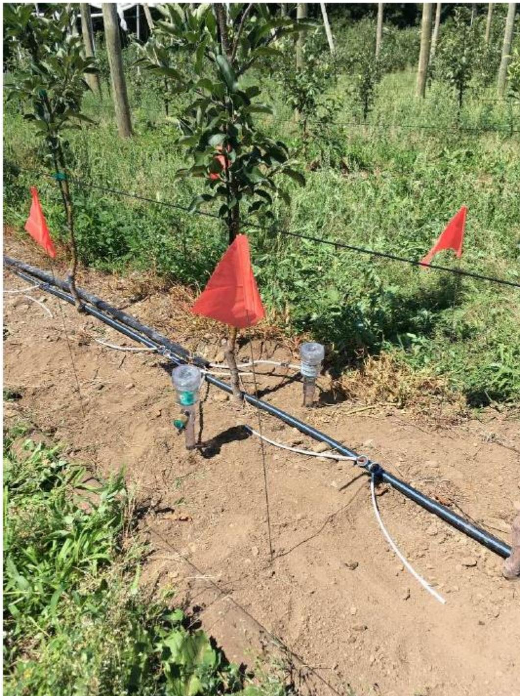
Figure 21. Irrrometer (SimpliCollect), verger
