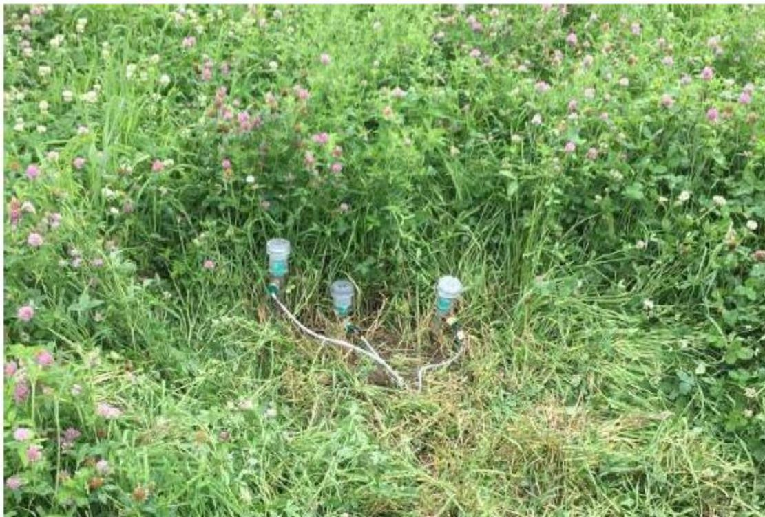
Figure 15. Tensiomètres Irrrometer (SimpliCollect), prairie
