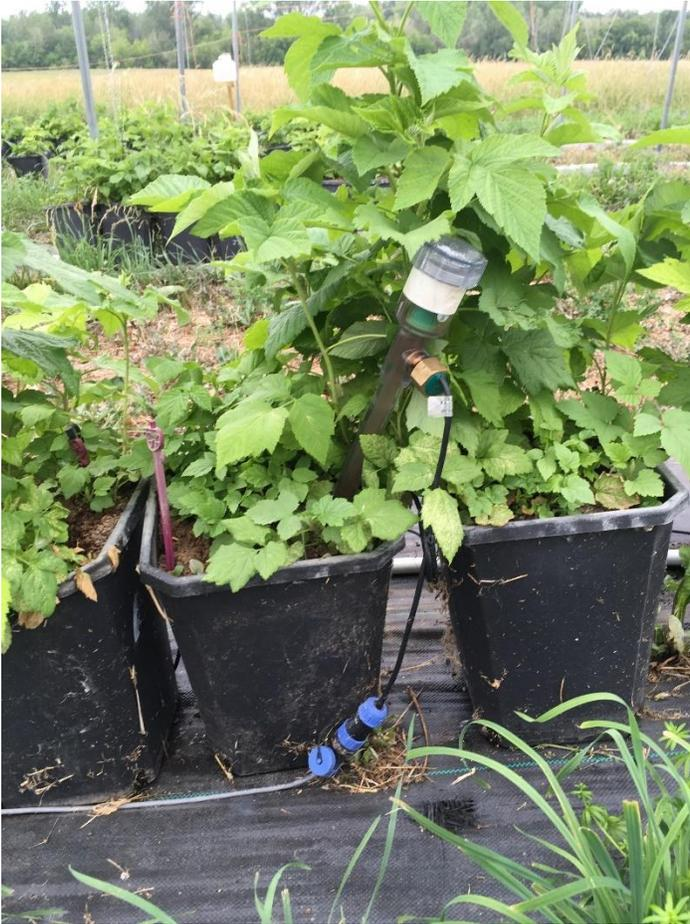
Figure 14. Tensiomètre Irrometer (Orisha), framboisiers en pots sous abris
