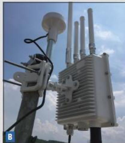
**Description:** Cet outil d'aide à la décision est composé d'un petit tensiomètre (photo **A**) qui communique à une antenne (photo **B**) située sur le toit d'un bâtiment au site de mesure. Le tensiomètre est positionné dans le substrat au centre du pot.
