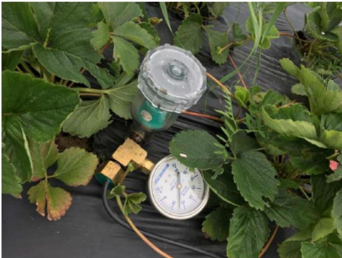
Figure 17. Tensiomètre Irrrometer (SimpliCollect), fraises sur sol butté recouvert de plastique
