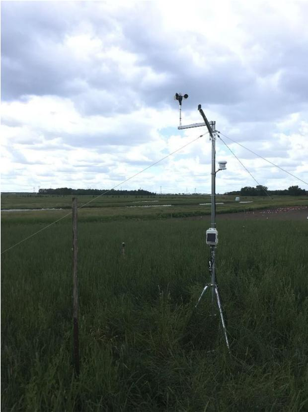
Figure 7. Trépied, anémomètre, pyranomètre et sonde de température et humidité relative de Onset (Hoskin Scientifique), prairie
