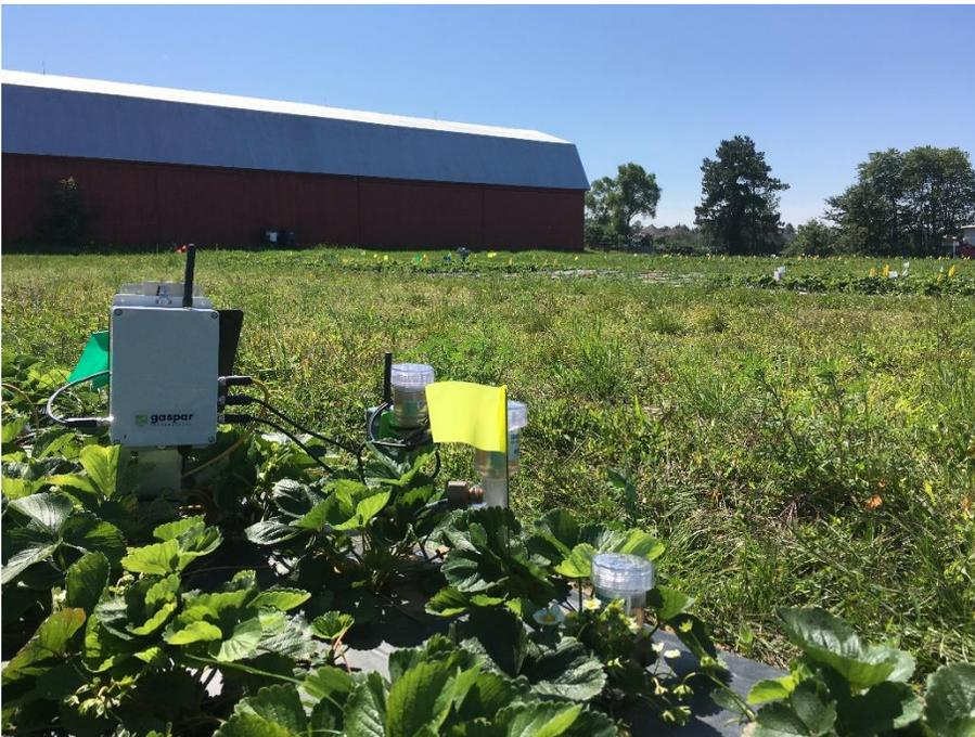
Figure 4. Station NGT-T4 (Gaspar), tensiomètres Irrrometer (Gaspar), fraises sur sol butté recouvert de plastique
