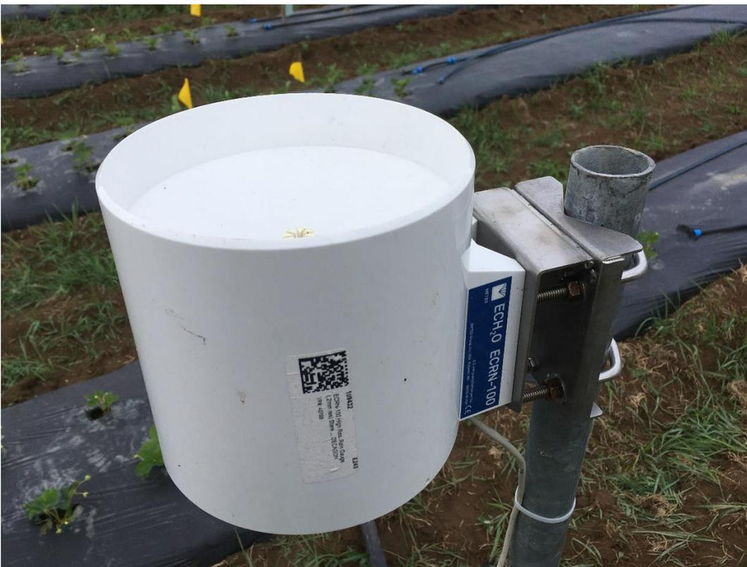
Figure 12. Pluviomètre ECRN-100 de Meter (Hoskin Scientifique), fraises sur sol butté recouvert de plastique
