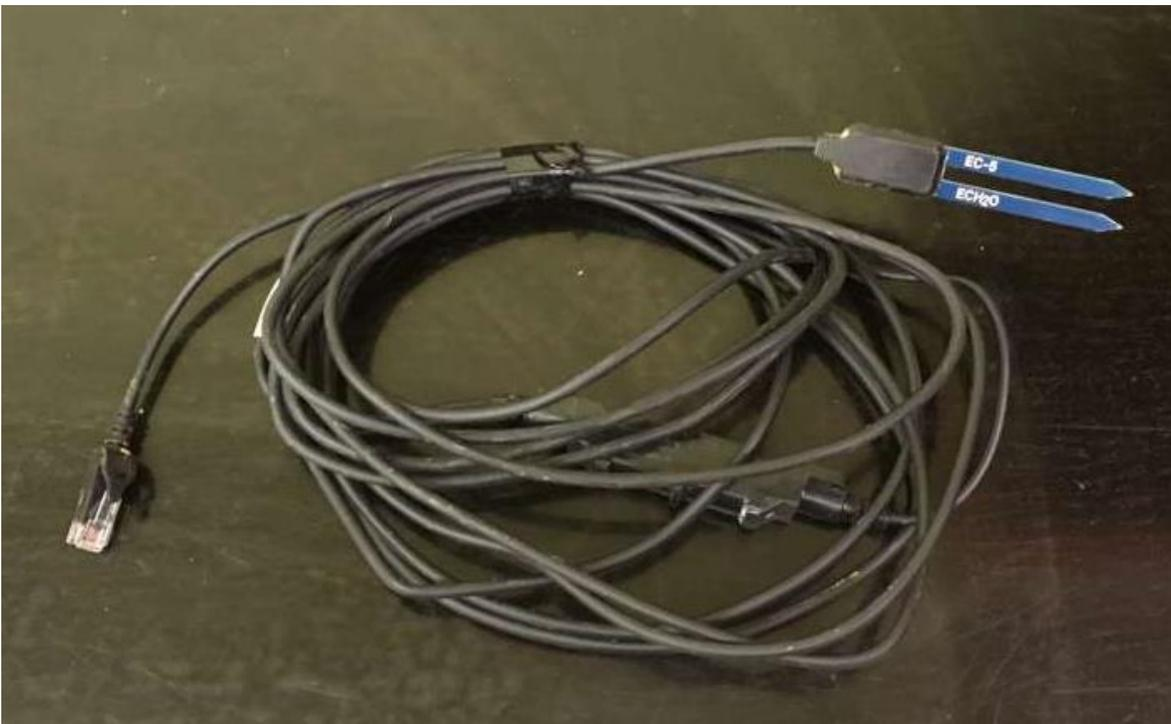
Figure 26. Sonde EC-5 de Meter (Hoskin Scientifique)
