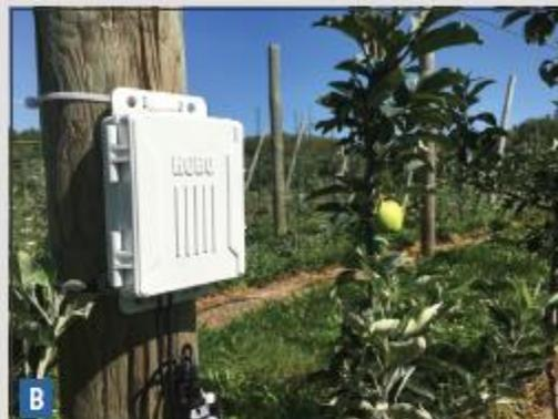
**Description :** Cet outil d'aide à la décision est composé de deux sondes de teneur en eau EC-5 (photo **A**) reliées à un enregistreur HOBO H21-USB (photo **B**). Ce dernier est fixé à un poteau de palissage. Les sondes sont positionnées à 30 et 60 cm de profondeur sur la ligne de plantation. L'accès aux données est possible uniquement en se connectant par câble à l'enregistreur. Il faut donc être au site de mesures pour y accéder.
