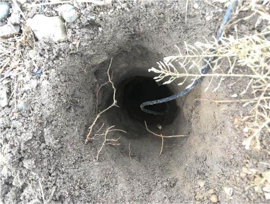
Figure 15. Installation de sondes EC-5 de Meter (Hoskin Scientifique), verger de pommiers
