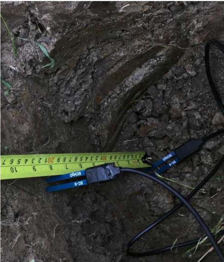
Figure 6. Installation de sonde EC-5 de Meter (Hoskin Scientifique), prairie
