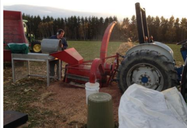
Figure 2 : Épandeur d'azote en postlevée à deux rangs (a) et batteuse stationnaire pour le battage du grain (b).
