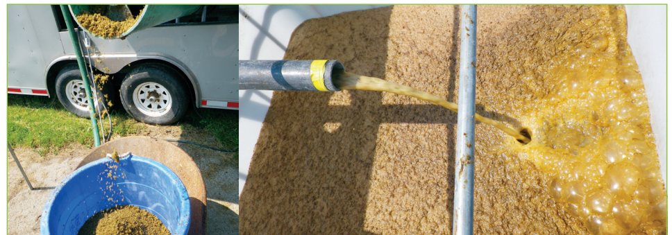
FIGURE 2 Fractions solide et liquide obtenues à la sortie du séparateur décanteur-centrifuge
