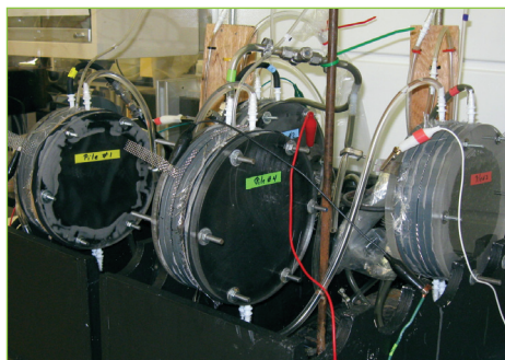
FIGURE 4 Montage expérimental de quatre piles bioélectrochimiques
