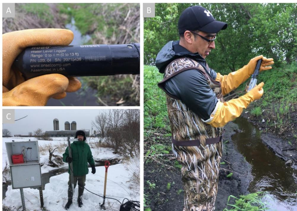
**Figure 4.** Sonde barométrique HOBO (A), récolte des données de la sonde barométrique à la station 16\_MOR (B) et sonde acoustique ISCO à la station 16\_CAS et son dispositif d'alimentation installé sur la rive (C).
