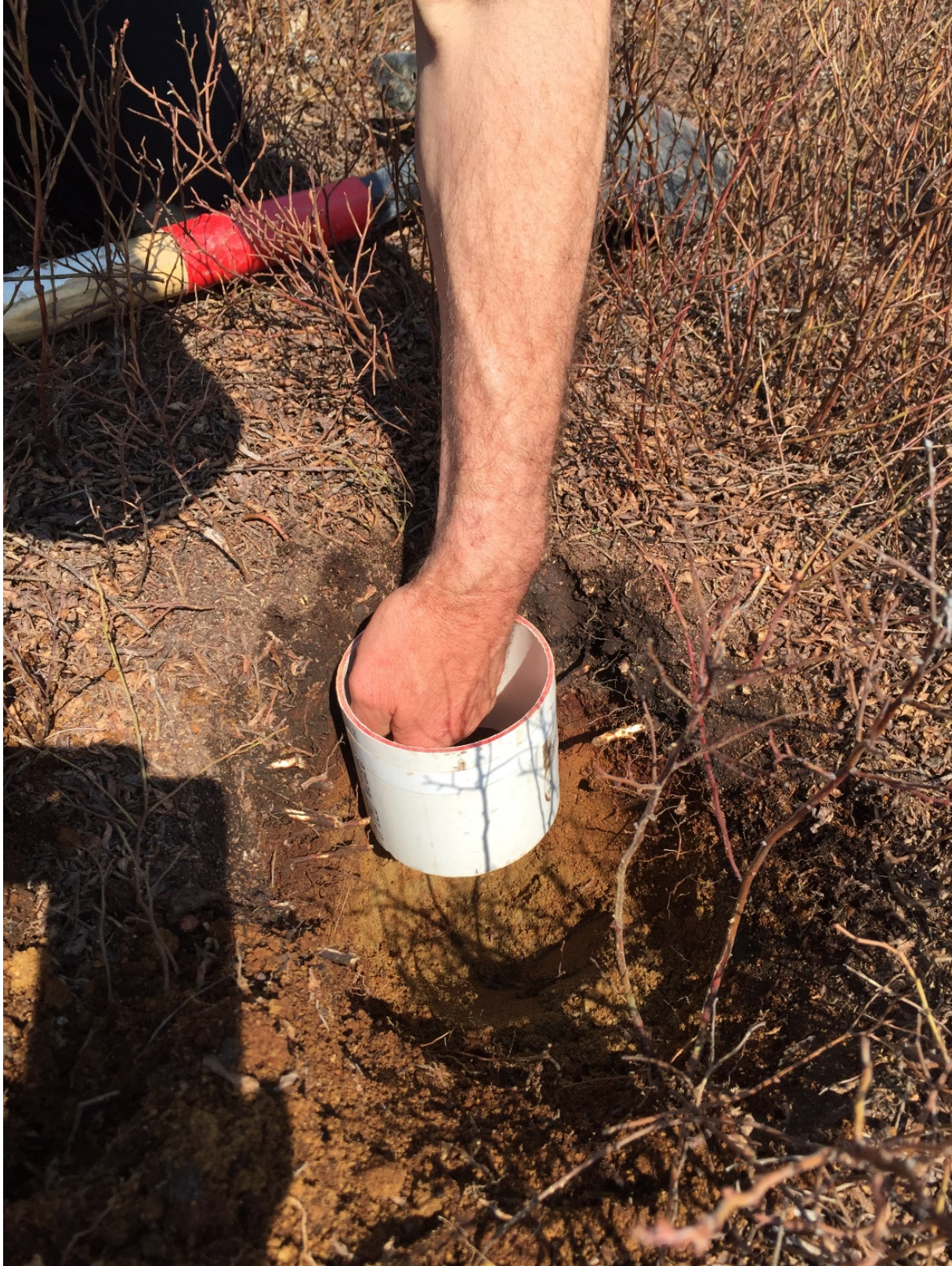
Figure 66 : Cylindre de PVC utilisé pour l'échantillonnage 0-15 cm (courbe de désorption en eau du sol).
