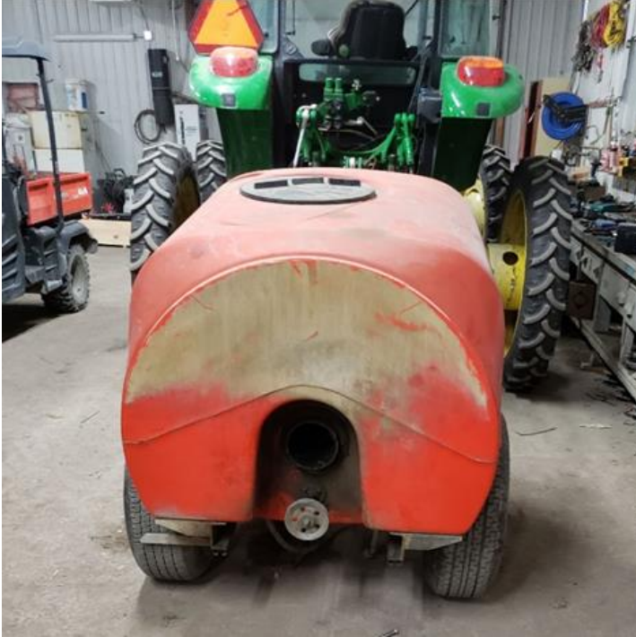
Figure 5. Pulvérisateur d'origine après démontage du ventilateur.
