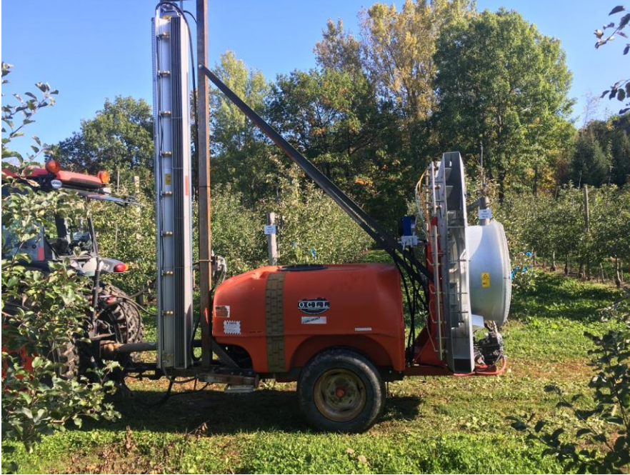
Figure 9. Pulvérisateur rénové avec des ventilateurs Aircheck actionnés par des moteurs hydrauliques.
