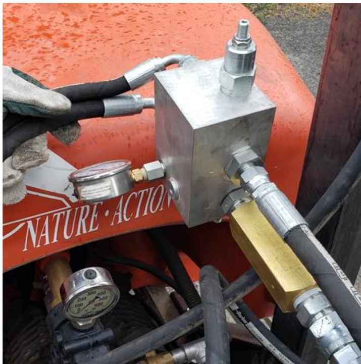
Figure 6. Bloc hydraulique de régulation de pression et de débit du pulvérisateur Weber.
