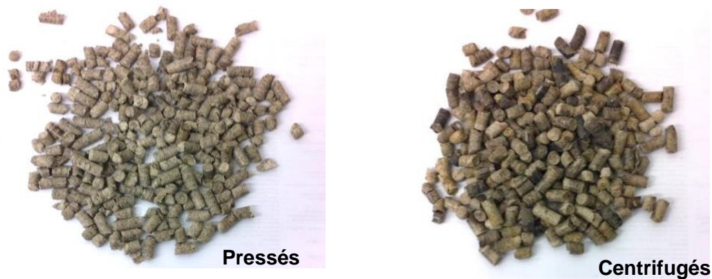
Figure 19. Granules de pommes de terre pressées et centrifugées (FS sèches) sans ajout d'eau lors de la granulation.
