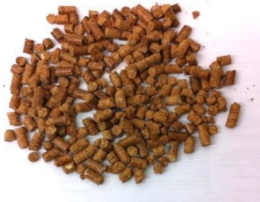
Figure 18. Granules de carottes centrifugées (FS sèche) sans ajout d'eau lors de la granulation.
