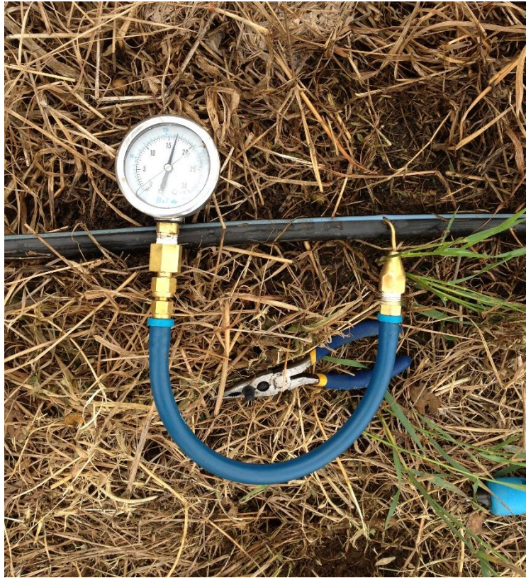
Figure 17. Mesure de la pression dans un tube de gag à l'aide d'un tube de Pitot.
