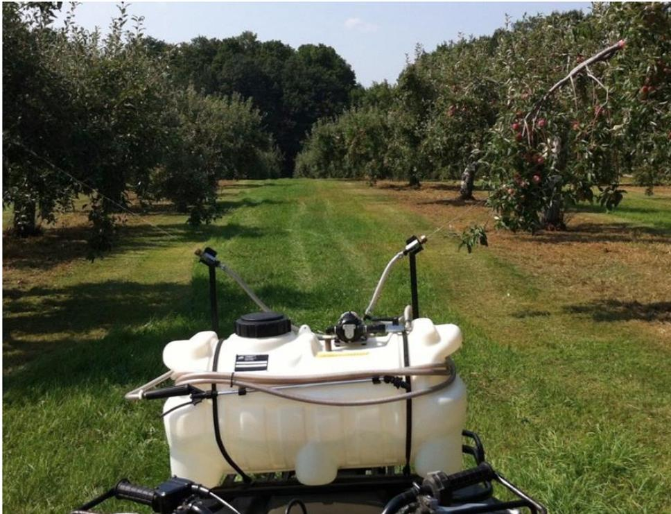
Figure 8. Applicateur à GF-120 avec une pompe, un réservoir et des buses montés sur un VTT (Source : IRDA).
