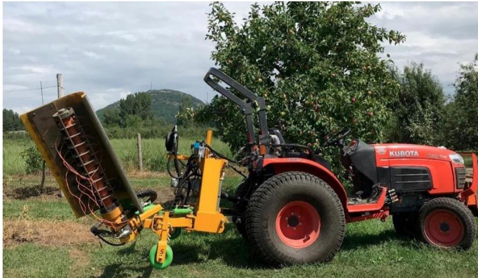
Figure 7. Désherbeur mécanique (Source : IRDA).
