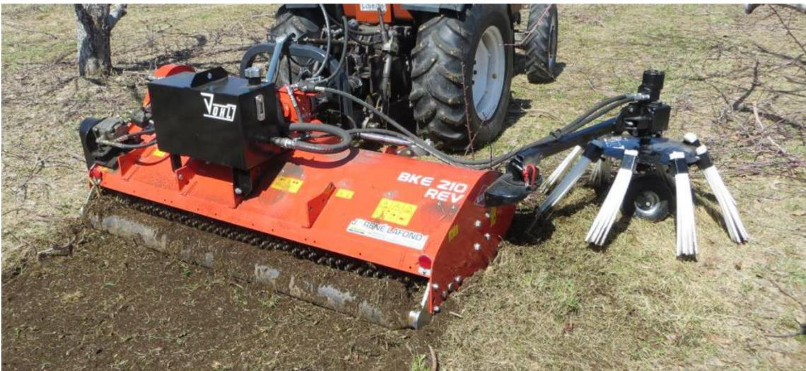
Figure 1. Équipement de broyage de la litière de feuilles et de branches Eliminae
