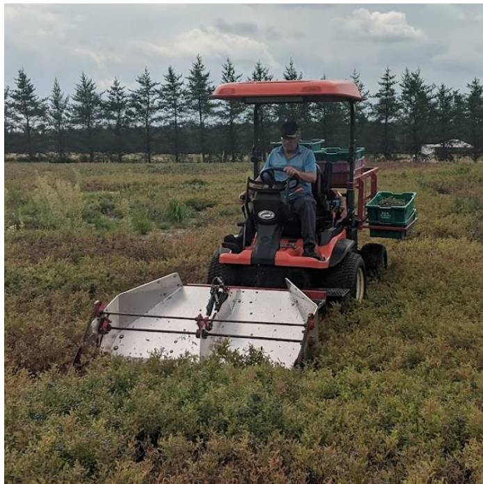
Figure 6. Cueilleuse motorisée : (a) vue d'ensemble et (b) vue sur le peigne et les boîtes à bleuets.
