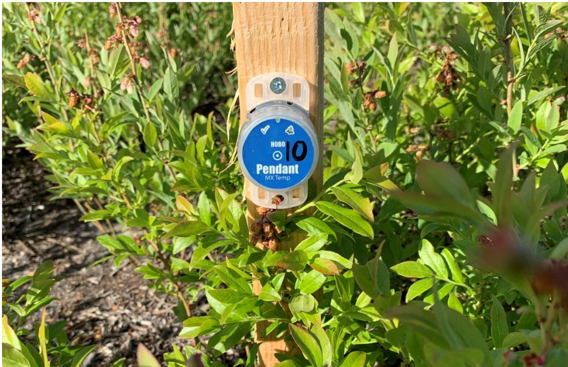
Figure 18. Capteur MX2201 (Onset) installé à la hauteur des fleurs pour le suivi de la température de l'air, photo prise à la suite des périodes de gels, 10 juin 2021. (Diamètre de la sonde : 18 mm).
