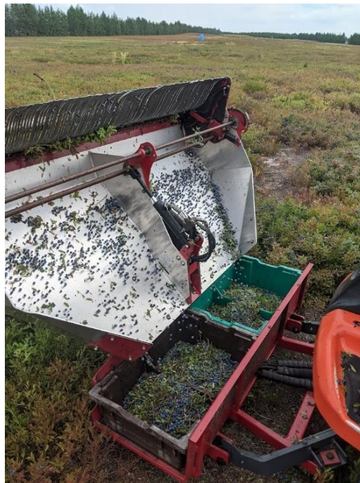
Figure 6. Cueilleuse motorisée : (a) vue d'ensemble et (b) vue sur le peigne et les boîtes à bleuets.
