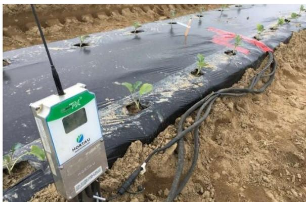
Figure 6. Module TX3 de Hortau et sondes de température, saison 2019.
