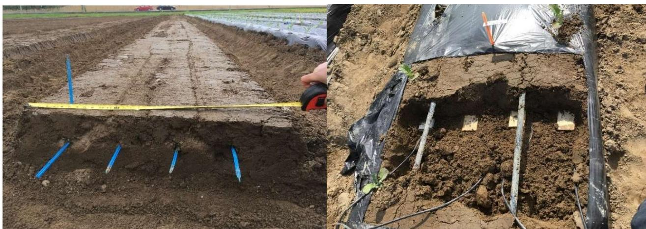
Figure 5. Représentation de l'emplacement des sondes TDR dans la butte (image de gauche) et sondes installées (image de droite), saison 2019.
