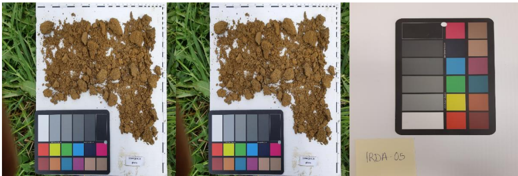
Figure 4 : Exemple de pré-traitement des images avec la charte de couleurs.
