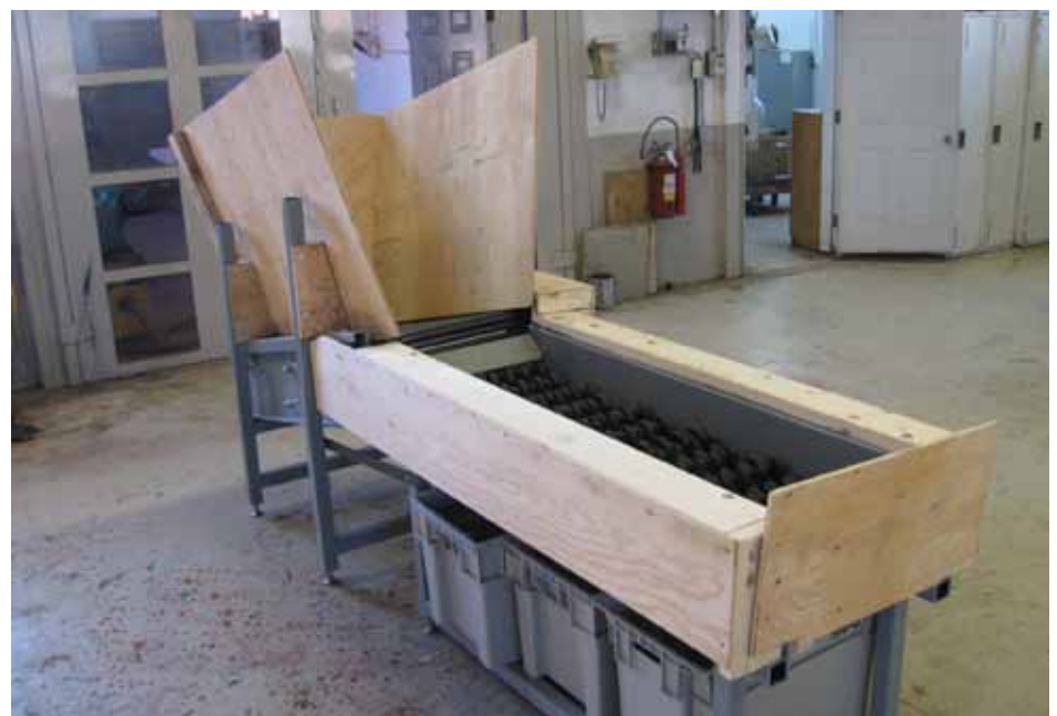
Figure 1. Unité de dessablage expérimentale.
