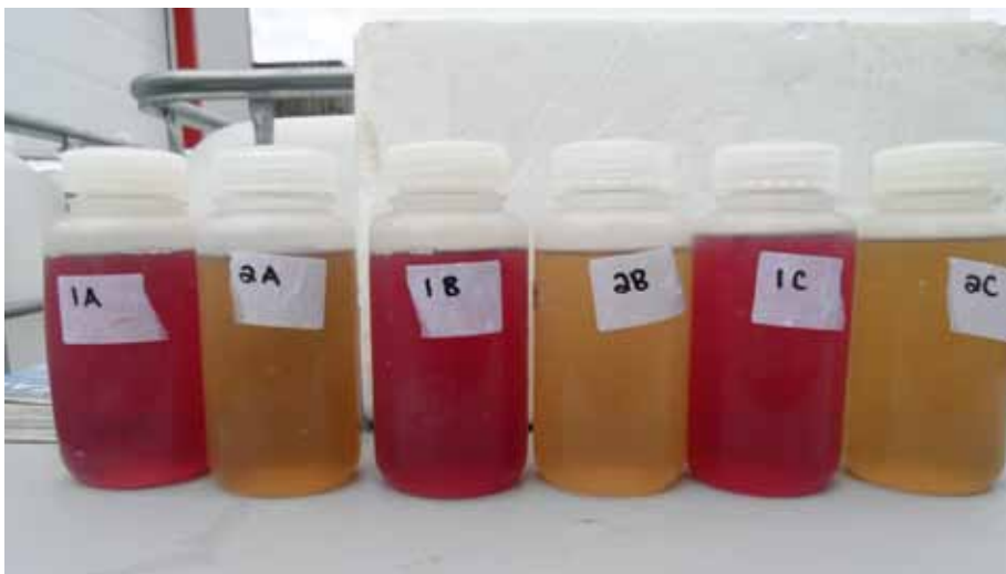
Figure 2. Échantillons prélevés après 4 jours d'aération au taux de 0,02 \text{ L}_{\text{air}} / \text{L}_{\text{eau}} \cdot \text{min} . Les échantillons rouges proviennent des bassins non aérés.
