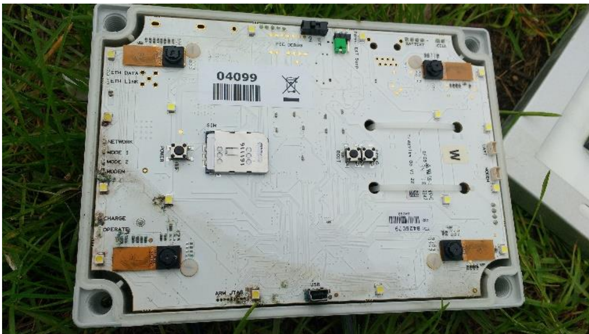
Figure 3. Signes d'infiltration d'eau dans un piège Trapview, observés le 29 mai 2019.
