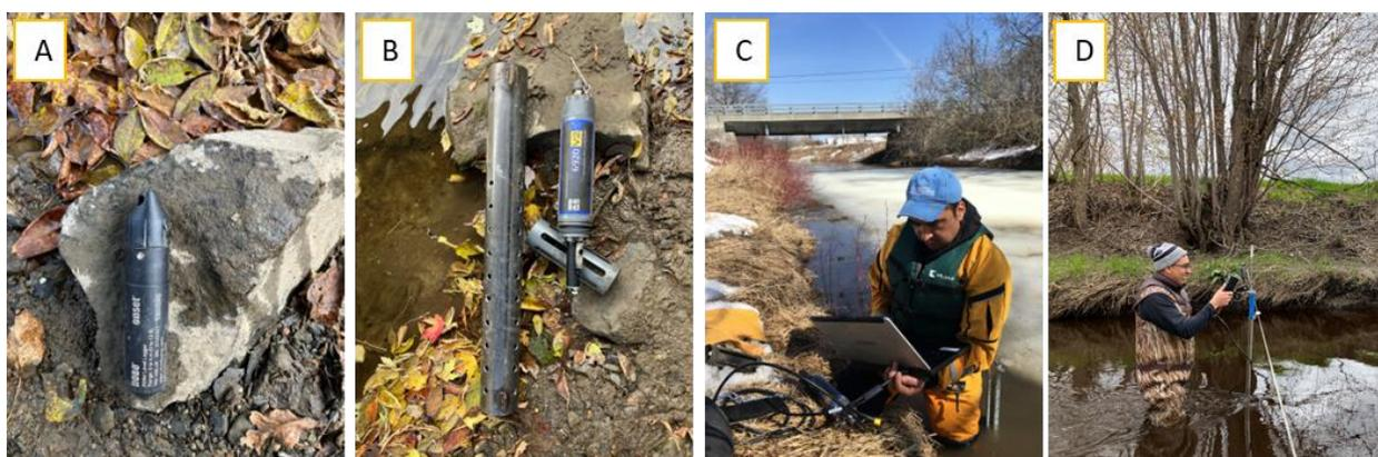
**Figure 13 : Installation et entretien des stations hydrologiques dans le bassin versant de la rivière Saint-Germain : sonde à pression (A), sonde multiparamètres YSI (B), entretien de la sonde YSI et récolte des données (C) et opération de jaugeage au débitmètre Flowtracker (D).**
