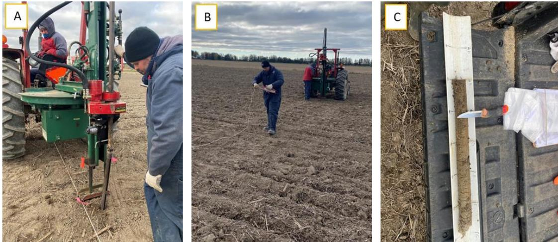
**Figure 4 : Prélèvement avec une sonde d'échantillonneur Giddings montée sur tracteur (A), piquetage des transects (B) et carottes de sol (C).**
