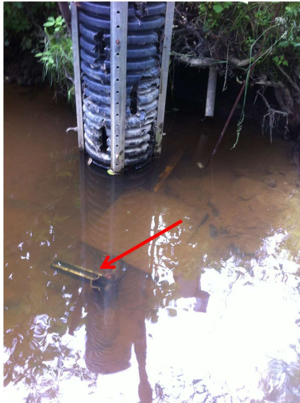
Figure 5. Entretien d'une sonde multi-paramètres (vue rapprochée) installée avec un dispositif de flottaison (en rouge) dans le tube de plastique perforé de pvc (en noir) à l'exutoire du micro-bassin de la rivière Noire.
