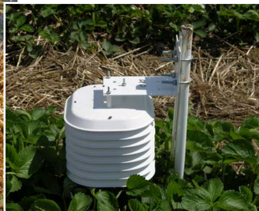
Figure 2. Sonde de température avec écran radial.
