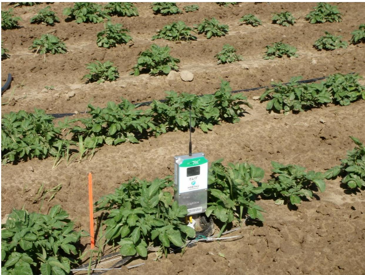
Photographie 2. Tensiomètre de marque Hortau (modèle TX-3).
