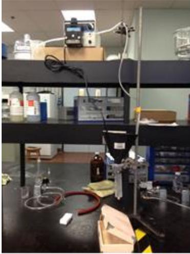
**Figure 1.2** Simulateur de pluie
