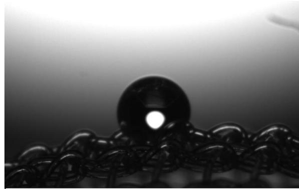
**Figure 1.3** Mesure de l'angle de contact sur un filet avec traitement au solvant (NeverWet)
