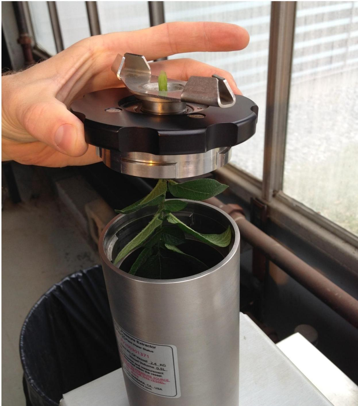
Photographie 9. Montage de l'échantillon à l'intérieur de la chambre à pression.
