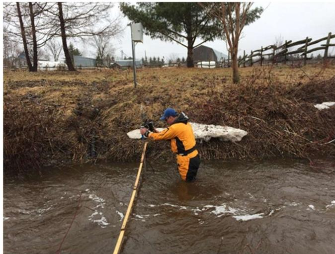
**Figure 3.3 : Mesures du débit instantané, à l'aide du moulinet hydrométrique, à la station EPERLAB**
